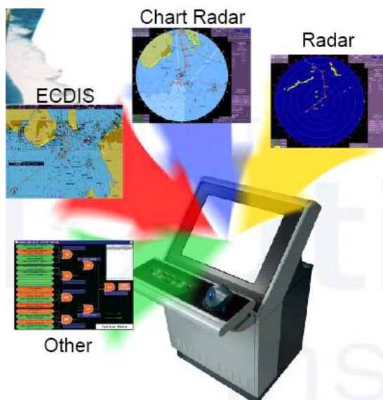
Slika 86. Integriran elektronički navigacijski sustav
