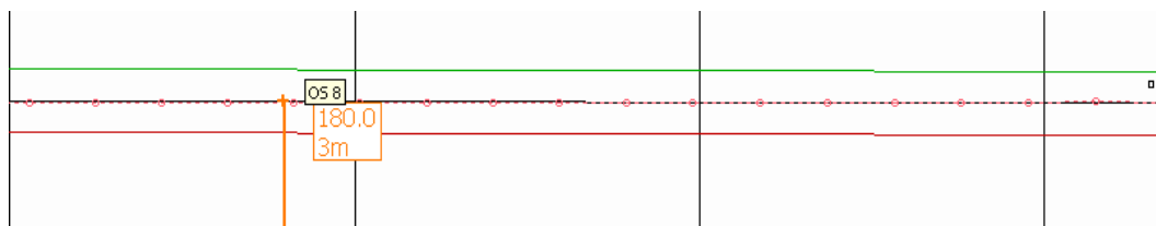
Slika 15. Grafički prikaz odstupanja izabranog modela kontejnerskog broda od linije ucrtanog kursa pri NE vjetru brzine 7 bf te valovima iz NE visine 5,5 m
