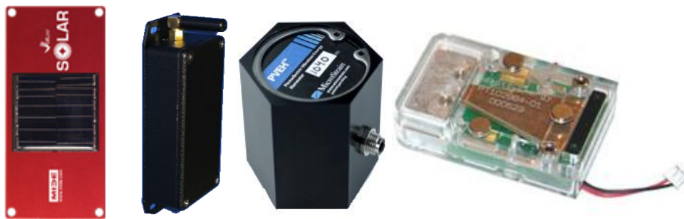
Slika 23. Komercijalno dostupni uređaji za pretvaranje kinetičke energije vibracija u električnu energiju temeljeni na piezoelektričnom efektu: Midé Volture (kombinacija sa solarnom žetvom energije), Advanced Cerametrics, Microstrain i AdaptivEnergy [URL: Advanced Cerametrics, URL: Mide, URL: AdaptivEnergy, URL: Microstrain]
