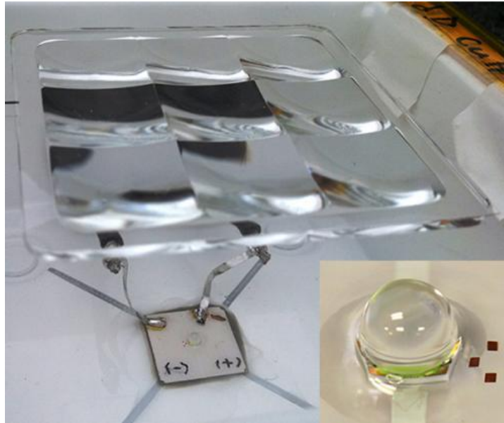
Slika 8. Minijaturna solarna ćelija s dvostrukim sustavom fokusiranja svjetlosti površine 2 cm x 2 cm [Sheng et al., 2014.]
