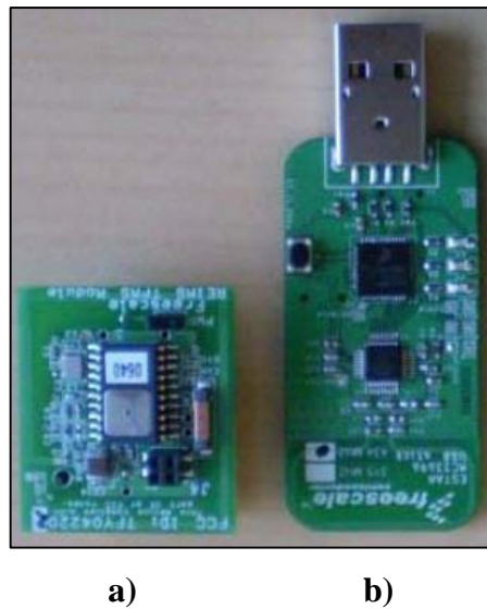
Slika 124. Freescale MPXY8300 mjerni modul: a) bežični primopredajnik i mjerač i b) USB sučelje s primopredajnikom [Petković, 2011.]
