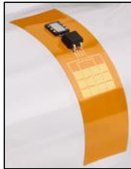
Slika 25. Piezoelektrična membrana za pretvaranje niskorazinske energije unutarnjih ljudskih organa u električnu energiju [Dagdeviren et al, 2013.].
