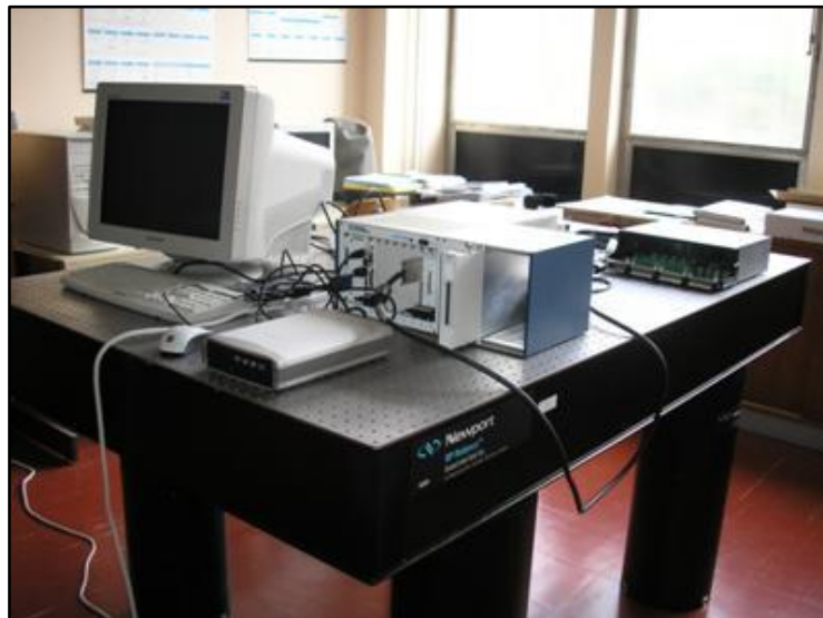
Slika 83. Optički stol Newport i sustav za prikupljanje podataka NI PXI
