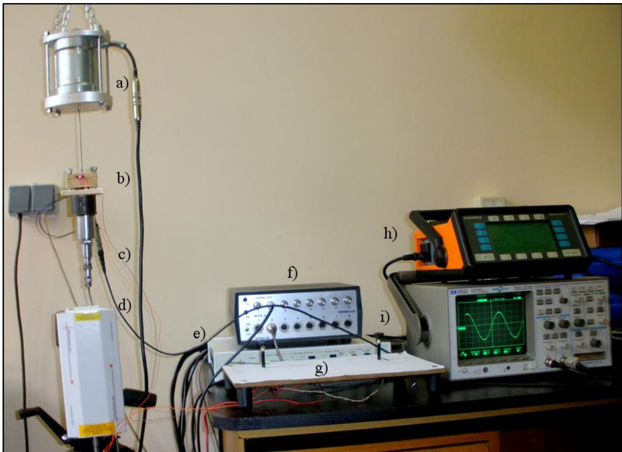
Slika 94. Eksperimentalni postav u Laboratoriju za precizno inženjerstvo: a) vibracijski uzбудnik Schenk AG Vibroexciter 41, b) uklješćenje konzole, c) akcelerometar Schenk AS-020, d) laserski vibrometar MetroLaser VibroMet 500V, e) upravljačka jedinica vibrometra, f) upravljačka jedinica akcelerometra, g) potenciometri, h) upravljačka jedinica vibracijskog uzбудnika, i) osciloskop
