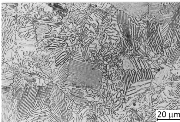
Slika 2.3. Karakteristična mikrostruktura perlita, 500:1
