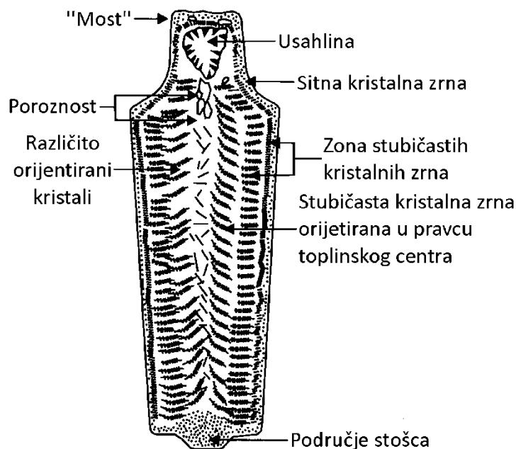
Slika 3.8. Shematski prikaz presjeka ingota
