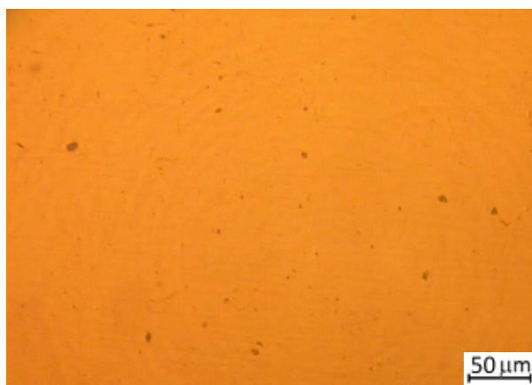
Slika 4.51. Metallografski snimak uzorka 8 nakon poboljšavanja, nenagrizano, polirano, 200:1
