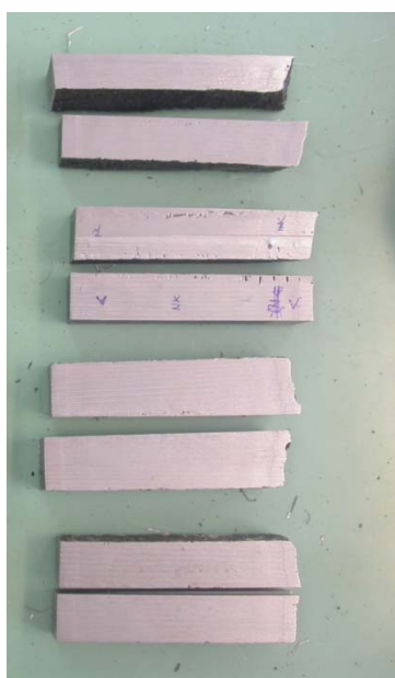
Slika 4.14. Gredice koje u odlivenom stanju idu na toplinsku obradu
