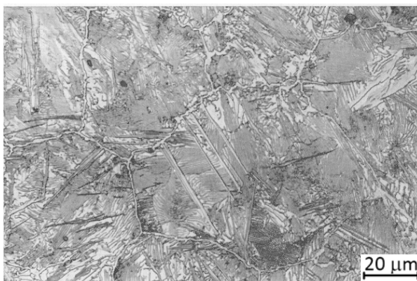
Slika 2.4. Karakteristična mikrostruktura perlita i sekundarnog cementita, 500:1
