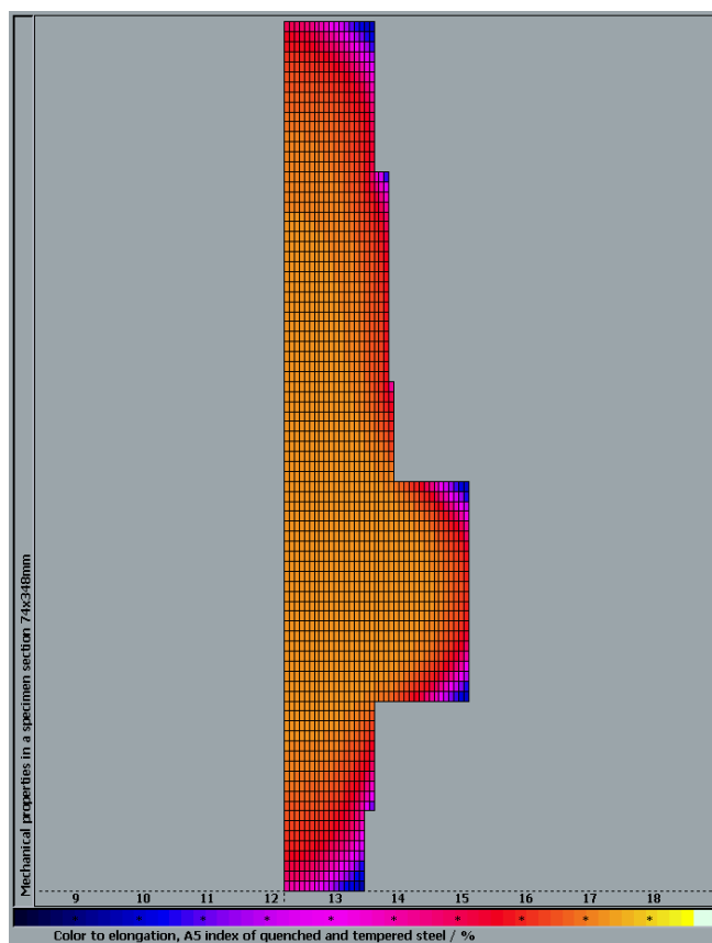
Slika 4.59. Raspodjela vrijednosti istezljivosti u poboljšanoj čeličnoj osovini
