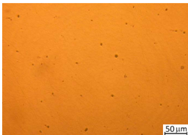
Slika 4.28. Metallografski snimak uzorka 2 nakon poboljšavanja, nenagrizano, polirano, 200:1
