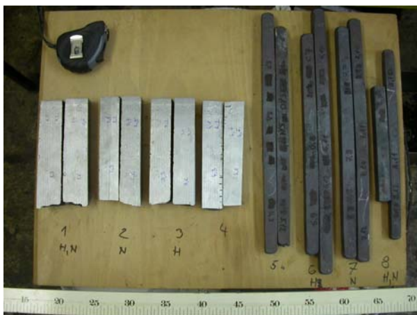
Slika 4.17. Gredice pripremljene za toplinsku obradu i plan toplinske obrade
