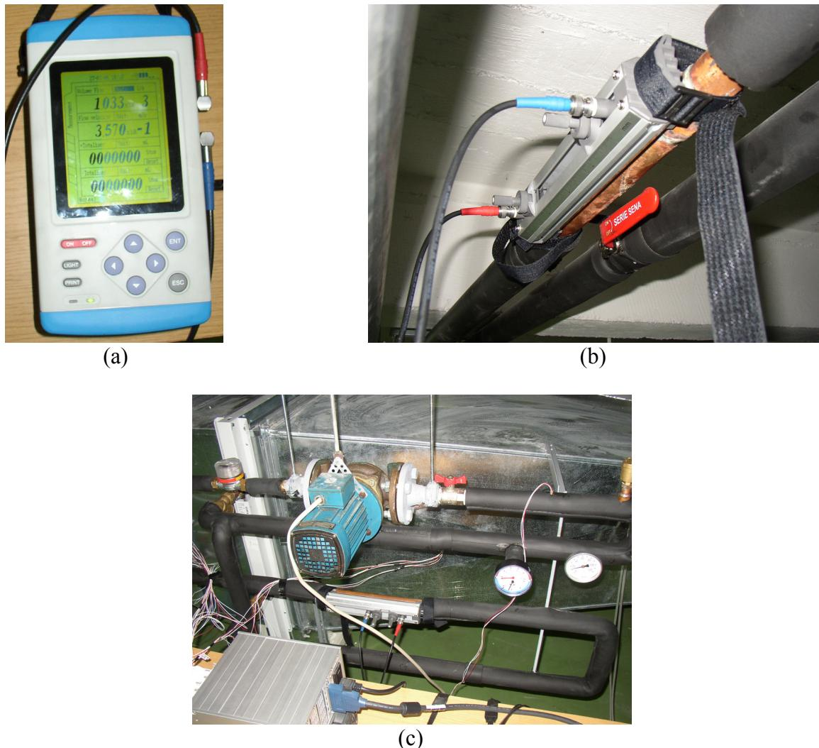
Sl. 4.16. Ultrazvučni uređaj za mjerjenje masenog protoka vode *Prosonic flow 92* (a) postavljen na sekundarni (b) i tercijarni krug radnog medija (c)
