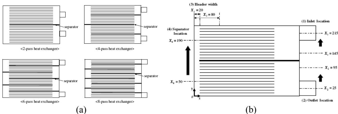
Sl. 6.2. Optimizacija geometrijskih parametara izmjenjivača topline prema Kimu [110]
