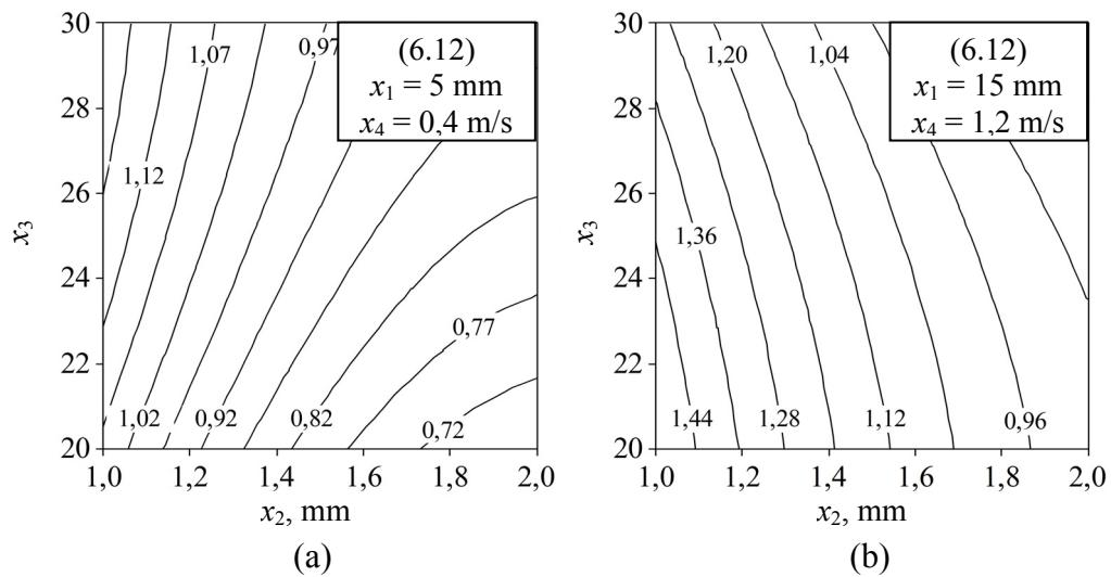
Sl. 6.25. Crteži obrisa odzivne plohe (6.12) u ovisnosti koraku lamela ( $x_2$ ) i broju malih kanala ( $x_3$ ). Konstantne vrijednosti su  $x_1 = 5 \text{ mm}$  i  $x_4 = 0,4 \text{ m/s}$  (a) te  $x_1 = 15 \text{ mm}$  i  $x_4 = 1,2 \text{ m/s}$  (b)
