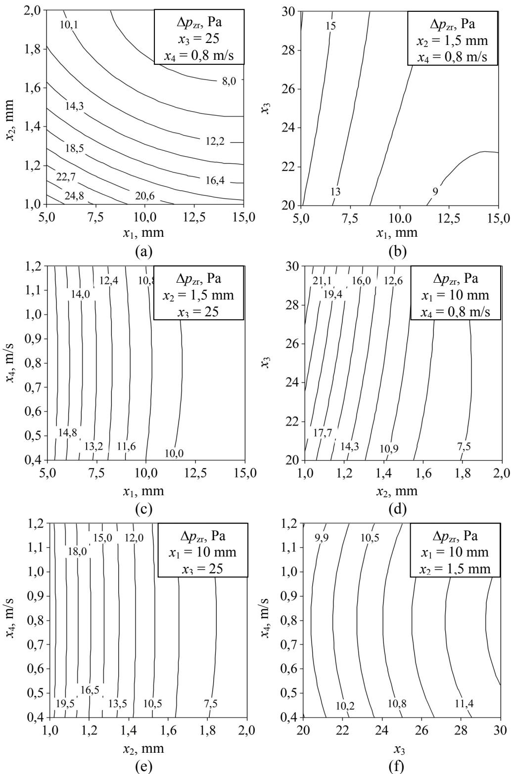
Sl. 6.15. Crteži obrisa odzivnih ploha za pad tlaka na strani zraka ( $z$ -os,  $\Delta p_{zr}$ ) u ovisnosti o koraku cijevi ( $x_1$ ), koraku lamela ( $x_2$ ), broju malih kanala ( $x_3$ ) i brzini vode na ulazu ( $x_4$ )
