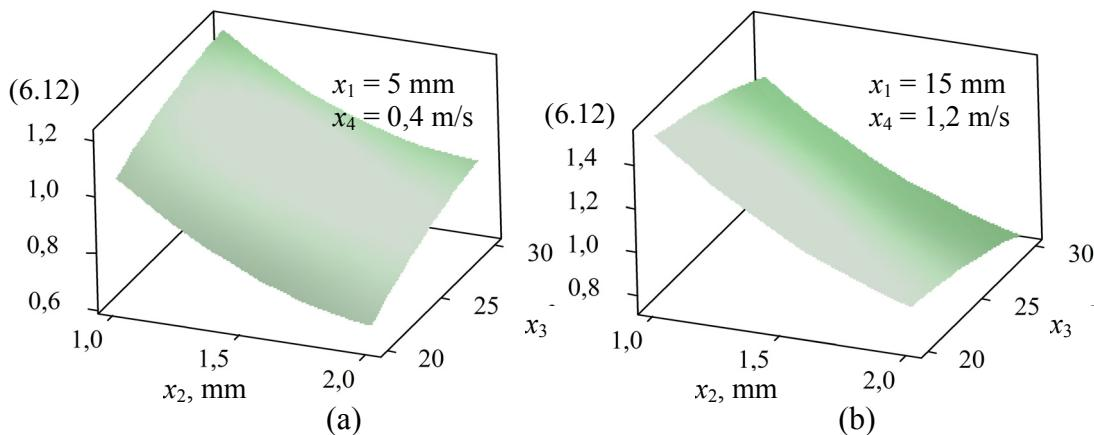
Sl. 6.24. Vizualizacija odzivnih ploha za (6.12) u ovisnosti koraku lamela ( $x_2$ ) i broju malih kanala ( $x_3$ ). Konstantne vrijednosti su  $x_1 = 5 \text{ mm}$  i  $x_4 = 0,4 \text{ m/s}$  (a) te  $x_1 = 15 \text{ mm}$  i  $x_4 = 1,2 \text{ m/s}$  (b)
