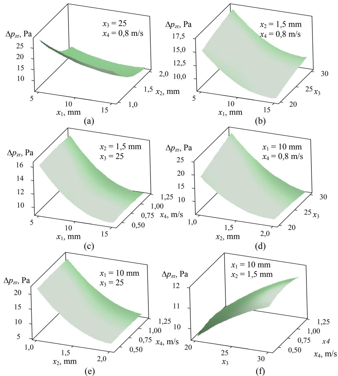
Sl. 6.14. Vizualizacija odzivnih ploha za pad tlaka na strani zraka ( $\Delta p_{zr}$ ) u ovisnosti o koraku cijevi ( $x_1$ ), koraku lamela ( $x_2$ ) broju malih kanala ( $x_3$ ) i brzini vode na ulazu ( $x_4$ )
