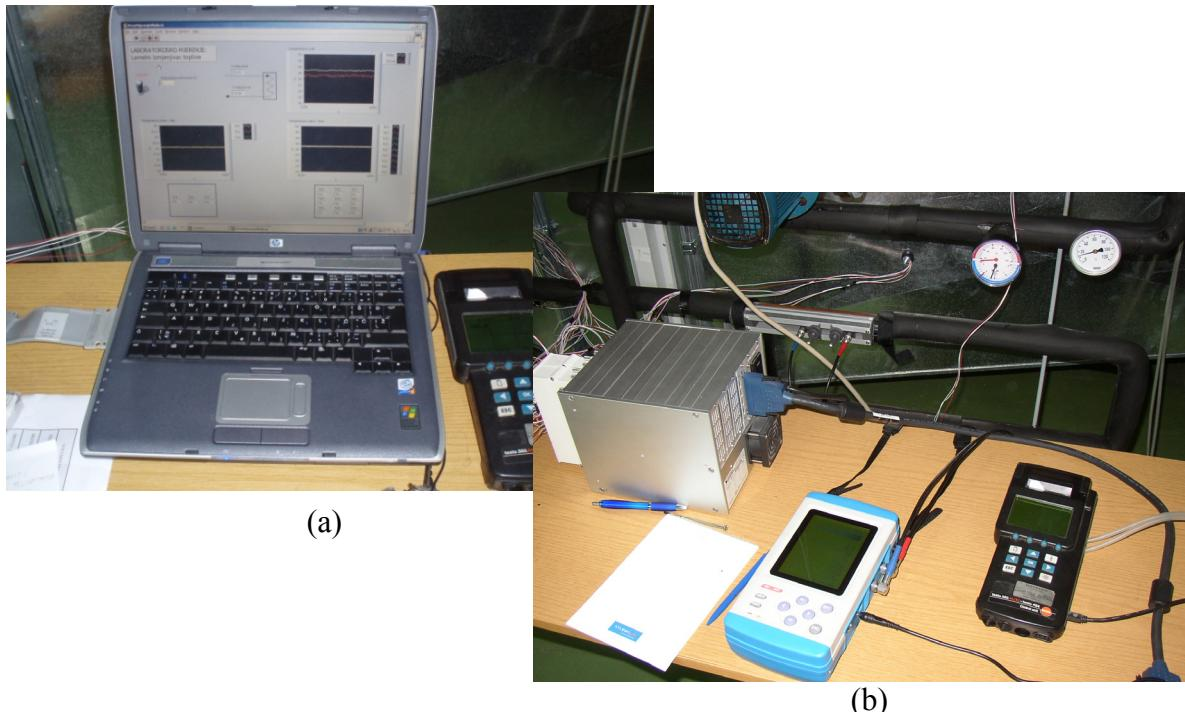
Sl. 4.20. Prijenosno računalo s pokrenutim virtualnim instrumentom (a) i uređaj za akviziciju podataka, uređaj za mjerjenje masenog protoka vode i uređaj za mjerjenje pada tlaka zraka (b)
