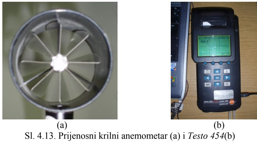
Sl. 4.13. Prijenosni krilni anemometar (a) i *Testo 454*(b)
