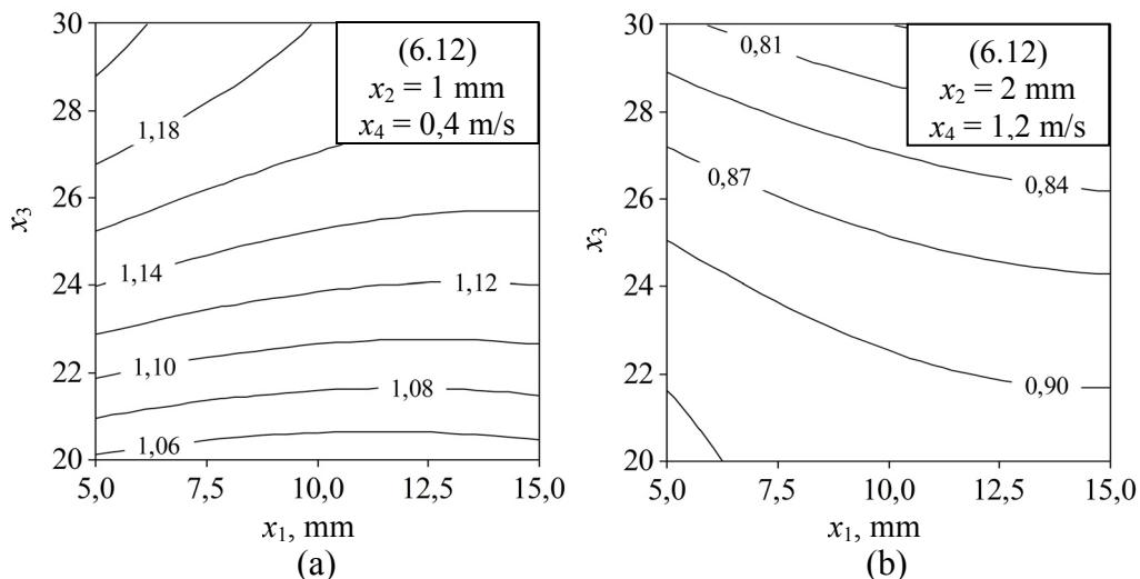
Sl. 6.21. Crteži obrisa odzivne plohe (6.12) u ovisnosti o koraku cijevi ( $x_1$ ) i broju malih kanala ( $x_3$ ). Konstantne vrijednosti su  $x_2 = 1 \text{ mm}$  i  $x_4 = 0,4 \text{ m/s}$  (a) te  $x_2 = 2 \text{ mm}$  i  $x_4 = 1,2 \text{ m/s}$  (b)
