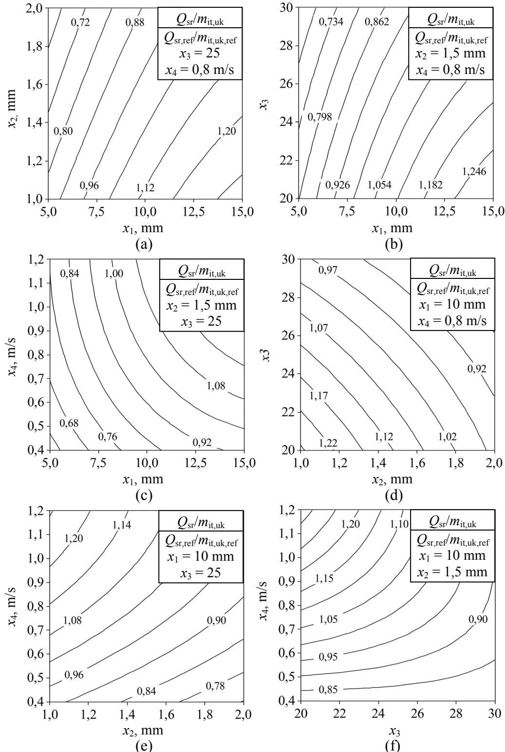
Sl. 6.11. Crteži obrisa odzivnih ploha za srednji izmijenjeni toplinski tok po jedinici ukupne mase izmjenjivača topline ( $z$ -os,  $(Q_{sr}/m_{it,uk})/(Q_{sr,ref}/m_{it,uk,ref})$ ) u ovisnosti o koraku cijevi ( $x_1$ ), koraku lamela ( $x_2$ ), broju malih kanala ( $x_3$ ) i brzini vode na ulazu ( $x_4$ )
