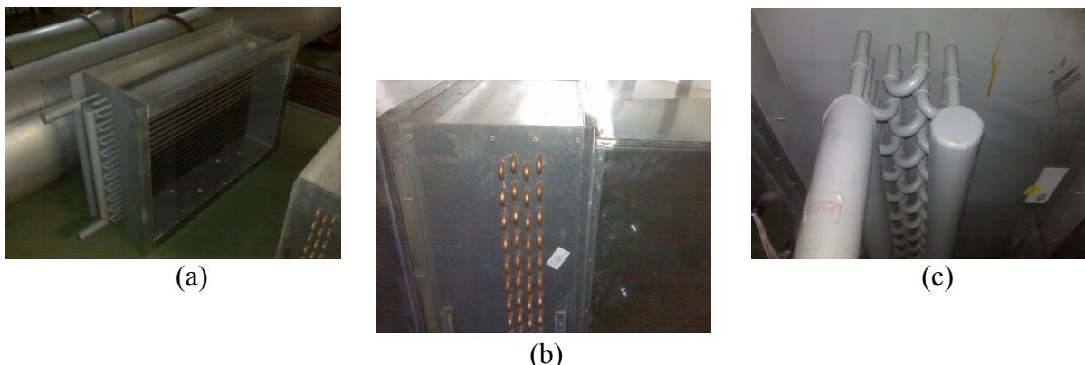
Sl. 2.1. Prostorni prikaz (a), desna (b) i lijeva strana s kolektorskim spojem (c) ispitivanog cijevnog lamelnog izmjenjivača topline
