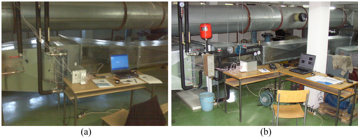
Sl. 4.8. Ispitna zona s ugrađenim cijevnim lamelnim izmjenjivačem topline (a) i lamelnim izmjenjivačem topline s mikrokanalima (b)
