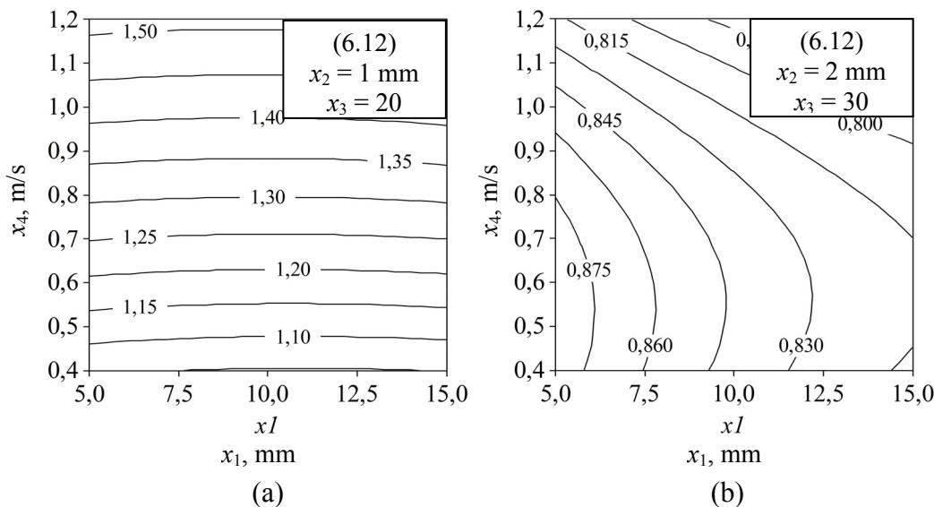
Sl. 6.23. Crteži obrisa odzivne plohe (6.12) u ovisnosti o koraku cijevi ( $x_1$ ) i brzini vode na ulazu ( $x_4$ ). Konstantne vrijednosti su  $x_2 = 1 \text{ mm}$  i  $x_3 = 20$  (a) te  $x_2 = 2 \text{ mm}$  i  $x_3 = 30$  (b)
