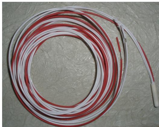
Sl. 4.9. Platinasti otpornički termometar, Pt100
