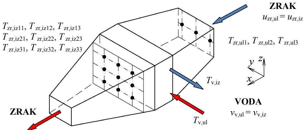
Sl. 4.22. Označavanje mjernih točaka u ispitnoj zoni
