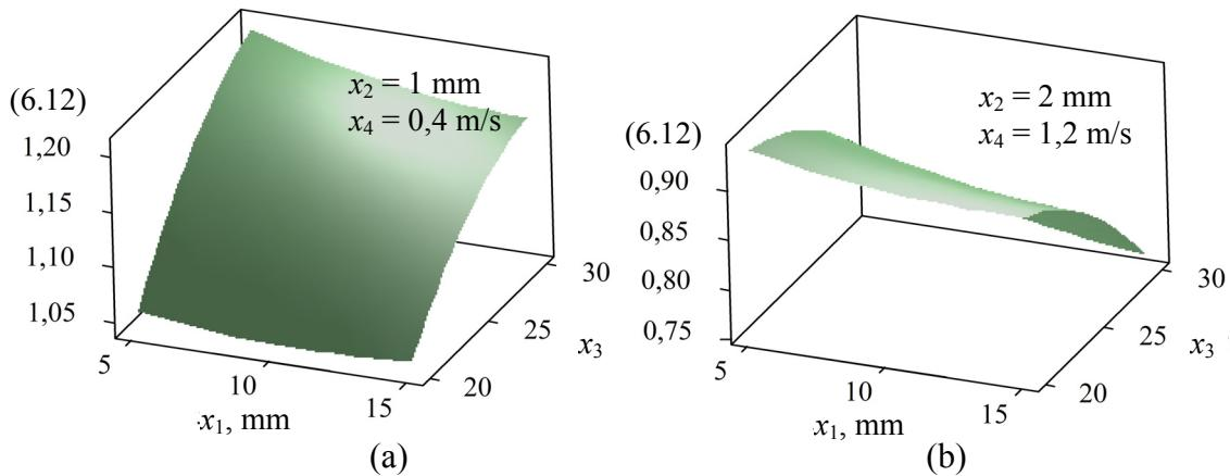
Sl. 6.20. Vizualizacija odzivnih ploha za (6.12) u ovisnosti o koraku cijevi ( $x_1$ ) i broju malih kanala ( $x_3$ ). Konstantne vrijednosti su  $x_2 = 1 \text{ mm}$  i  $x_4 = 0,4 \text{ m/s}$  (a) te  $x_2 = 2 \text{ mm}$  i  $x_4 = 1,2 \text{ m/s}$  (b)
