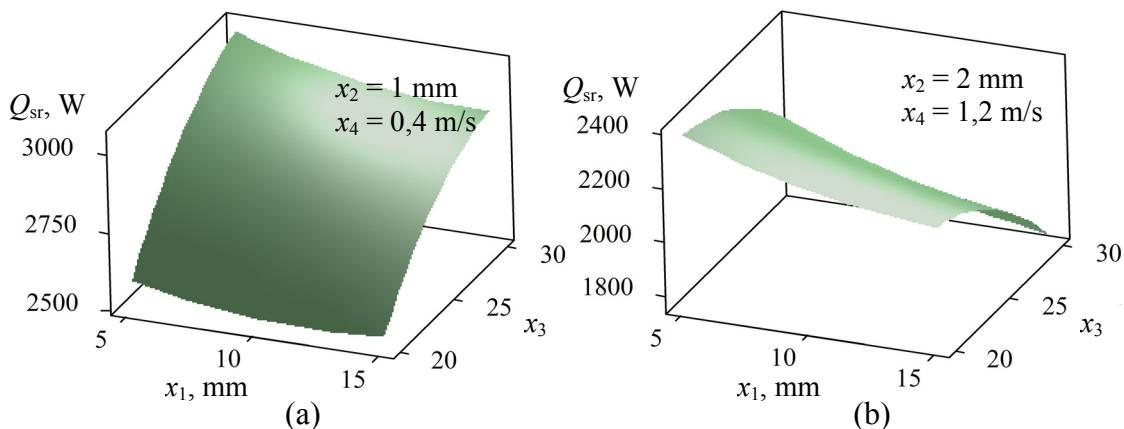
Sl. 6.8. Vizualizacija odzivnih ploha za srednji izmijenjeni toplinski tok ( $z$ -os,  $Q_{sr}$ ) u ovisnosti o koraku cijevi ( $x_1$ ) i broju malih kanala ( $x_3$ ). Konstantne vrijednosti su  $x_2 = 1 \text{ mm}$  i  $x_4 = 0,4 \text{ m/s}$  (a) te  $x_2 = 2 \text{ mm}$  i  $x_4 = 1,2 \text{ m/s}$  (b)
