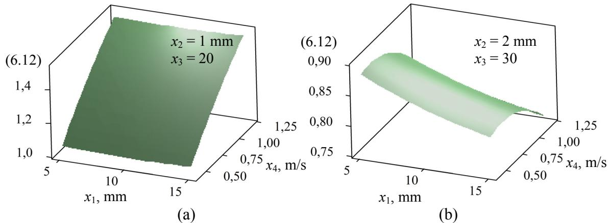
Sl. 6.22. Vizualizacija odzivnih ploha za (6.12) u ovisnosti o koraku cijevi ( $x_1$ ) i brzini vode na ulazu ( $x_4$ ). Konstantne vrijednosti su  $x_2 = 1 \text{ mm}$  i  $x_3 = 20$  (a) te  $x_2 = 2 \text{ mm}$  i  $x_3 = 30$  (b)
