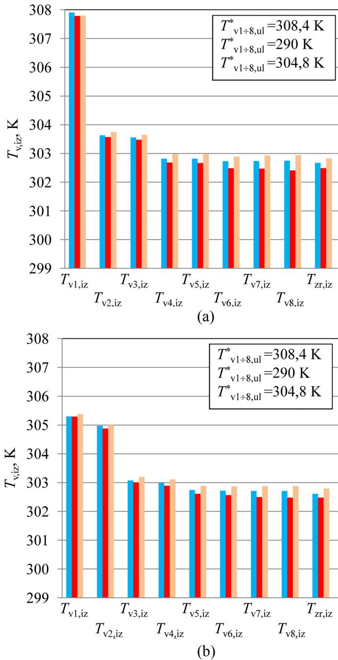
Sl. 3.15. Utjecaj pretpostavljenih temperatura na konačno rješenje kod cijevnog lamelnog izmjenjivača topline za blok 1 (a) i 5 (b)
