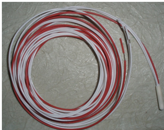
Sl. 4.9. Platinasti otpornički termometar, Pt100
