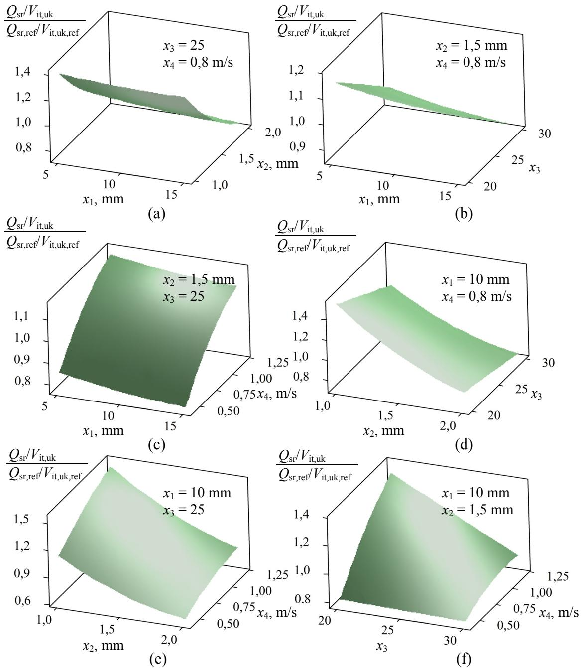
Sl. 6.12. Vizualizacija odzivnih ploha za srednji izmijenjeni toplinski tok po jedinici ukupnog volumena izmjenjivača topline ( $z$ -os,  $(Q_{sr}/V_{it,uk})/(Q_{sr,ref}/V_{it,uk,ref})$ ) u ovisnosti o koraku cijevi ( $x_1$ ), koraku lamela ( $x_2$ ), broju malih kanala ( $x_3$ ) i brzini vode na ulazu ( $x_4$ )
