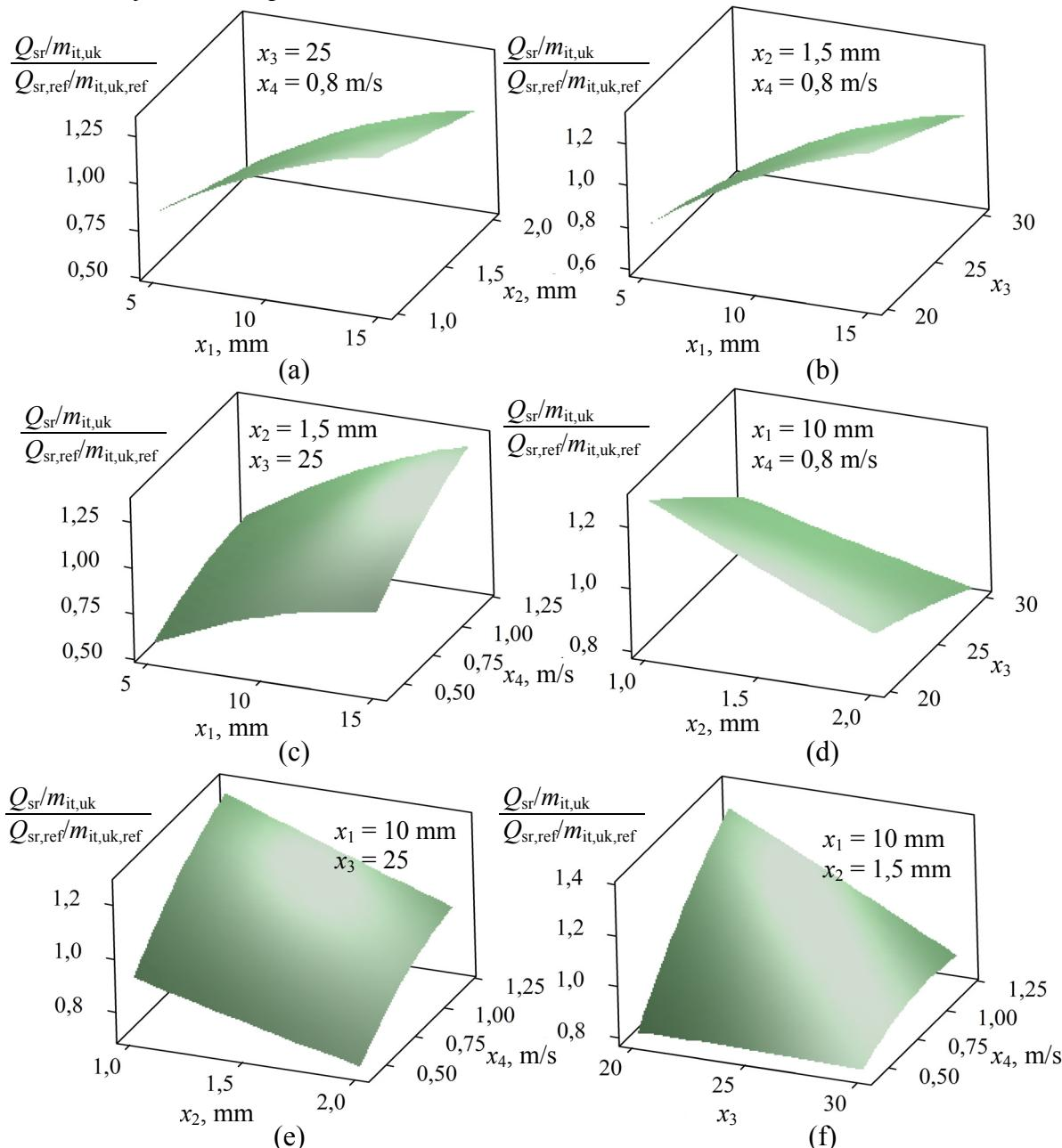
Sl. 6.10. Vizualizacija odzivnih ploha za srednji izmijenjeni toplinski tok po jedinici ukupne mase izmjenjivača topline (z-os,  $(Q_{sr}/m_{it,uk})/(Q_{sr,ref}/m_{it,uk,ref})$ ) u ovisnosti o koraku cijevi ( $x_1$ ), koraku lamela ( $x_2$ ), broju malih kanala ( $x_3$ ) i brzini vode na ulazu ( $x_4$ )
