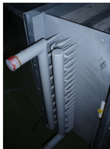
Sl. 4.2. Ispitna zona (a) i lijeva strana s kolektorskim priključcima (b) ispitivanog cijevnog lamelnog izmjenjivača topline
