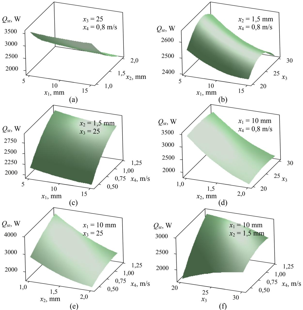
Sl. 6.7. Vizualizacija odzivnih ploha za srednji izmijenjeni toplinski tok (z-os,  $Q_{sr}$ ) u ovisnosti o koraku cijevi ( $x_1$ ), koraku lamela ( $x_2$ ), broju malih kanala ( $x_3$ ) i brzini vode na ulazu ( $x_4$ )
