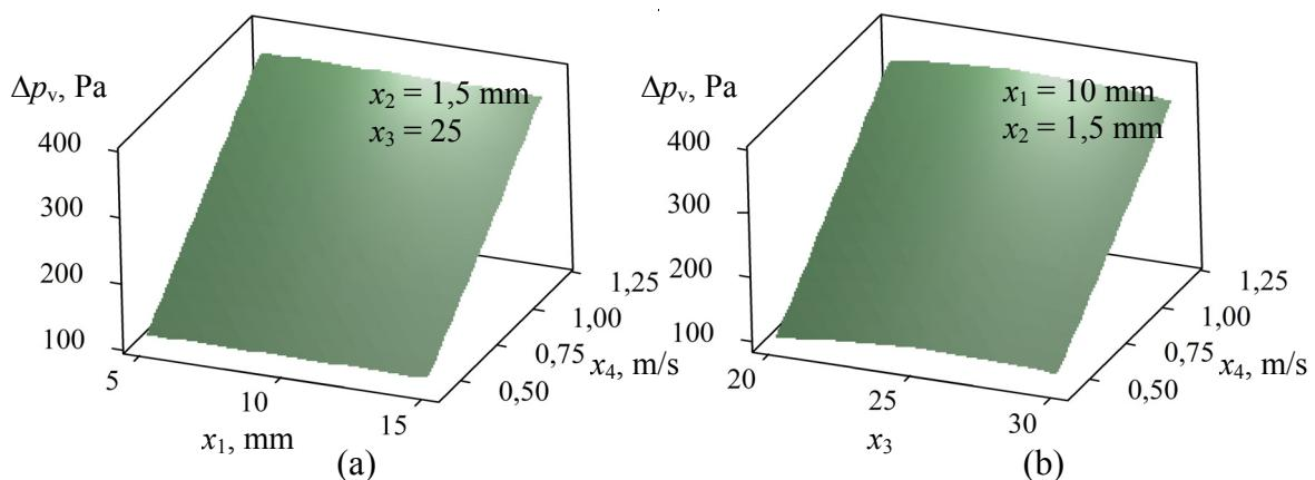
Sl. 6.16. Vizualizacija odzivnih ploha za pad tlaka na strani vode ( $\Delta p_v$ ) u ovisnosti o koraku cijevi ( $x_1$ ), broju malih kanala ( $x_3$ ) i brzini vode na ulazu ( $x_4$ )
