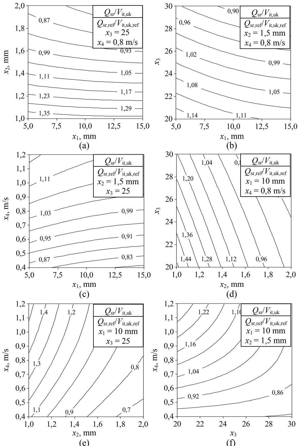
Sl. 6.13. Crteži obrisa odzivnih ploha za srednji izmjenjeni toplinski tok po jedinici ukupnog volumena izmjenjivača topline ( $z$ -os,  $(Q_{sr}/V_{it,uk})/(Q_{sr,ref}/V_{it,uk,ref})$ ) u ovisnosti o koraku cijevi ( $x_1$ ), koraku lamela ( $x_2$ ), broju malih kanala ( $x_3$ ) i brzini vode na ulazu ( $x_4$ )
