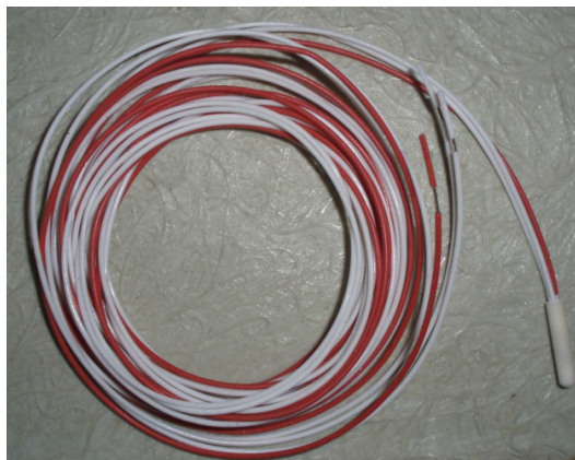
Sl. 4.9. Platinasti otpornički termometar, Pt100
