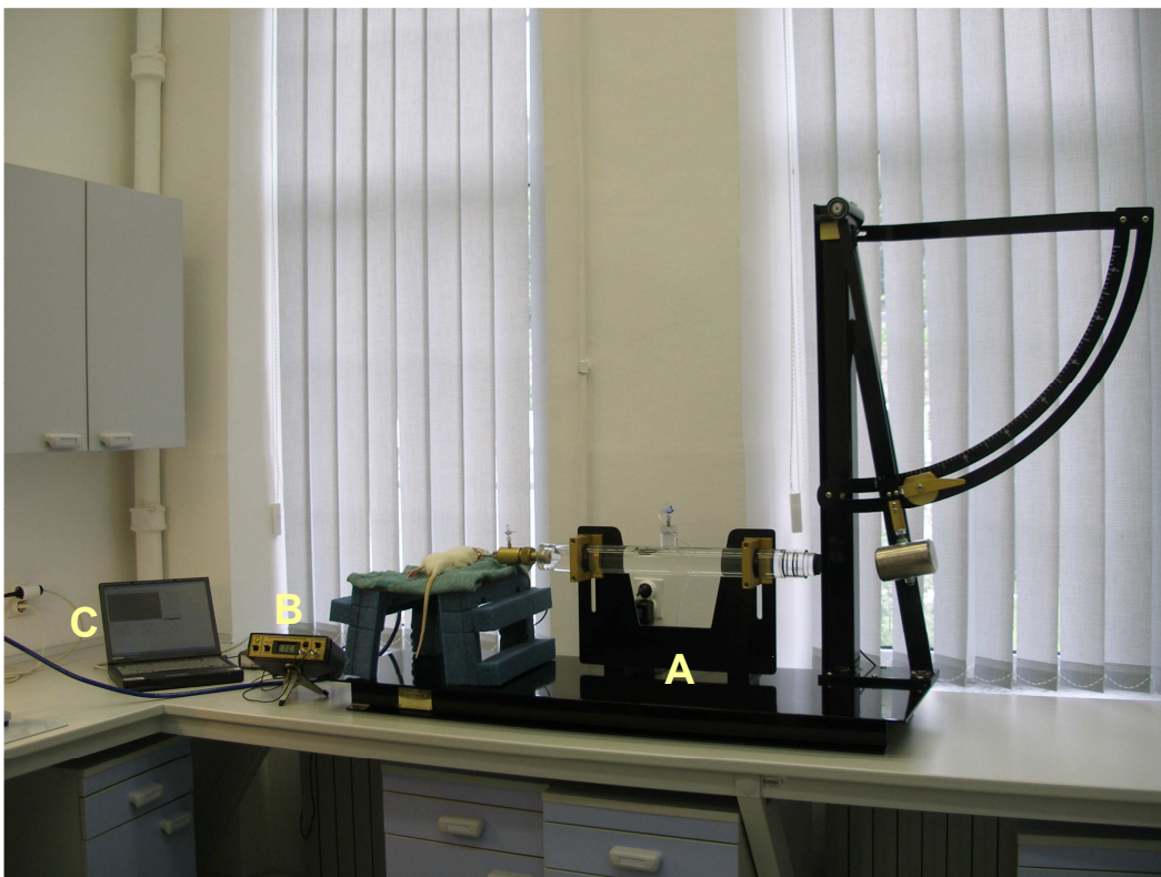
Slika 5. Sustav za LFP ozljedu u štakora: aparat za LFP ozljedu (A), osciloskop (B), računalo (C).
