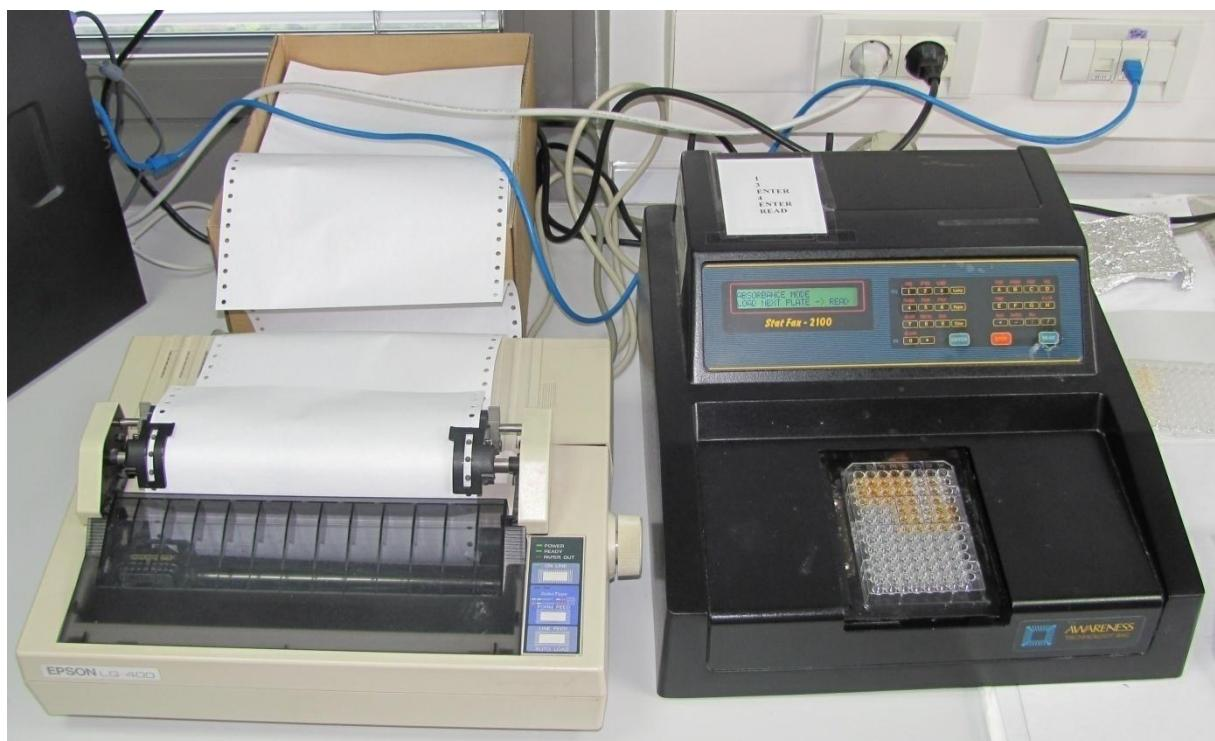
Slika 16. Spektrofotometar Start Fax 2010 za očitanje razine biljega oksidacijskog stresa
