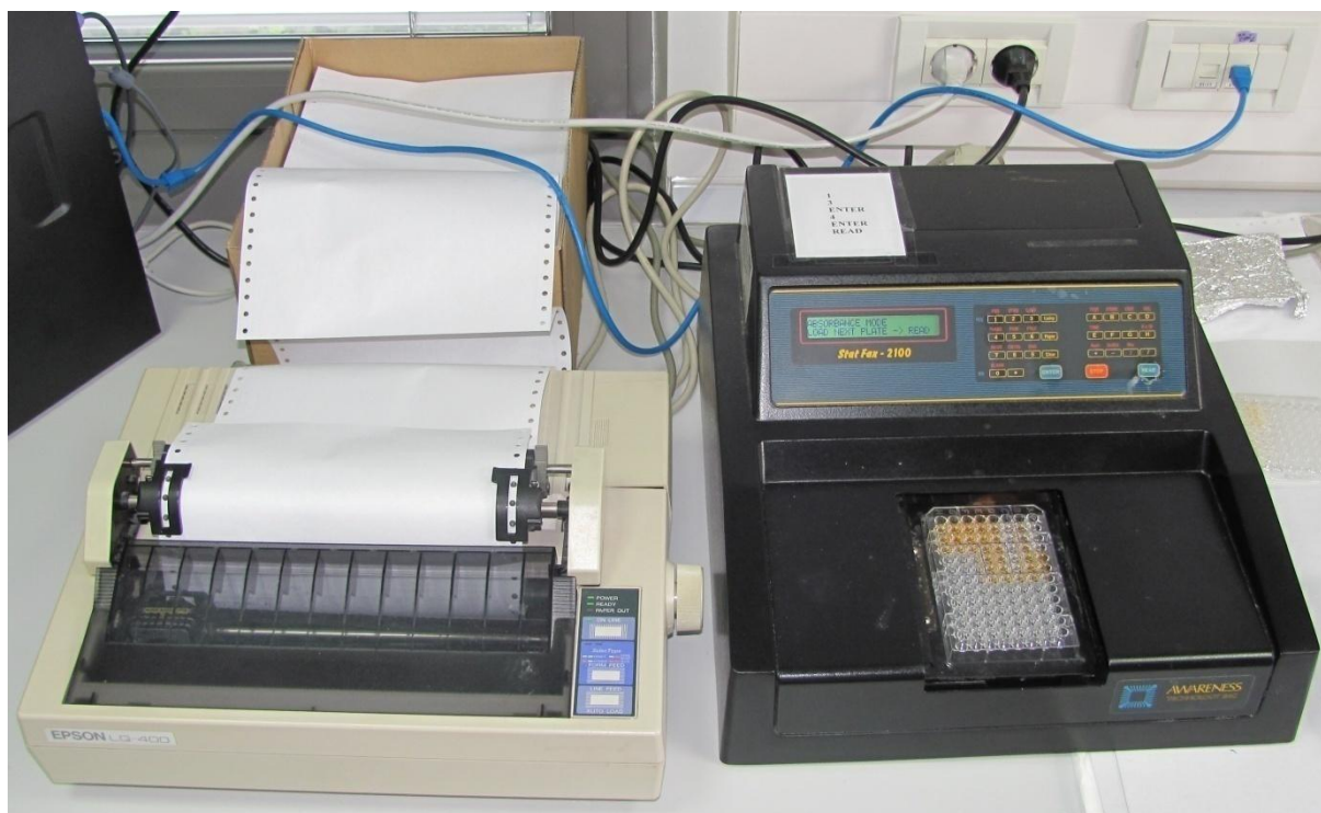
Slika 16. Spektrofotometar Stat Fax 2100 za očitavanje razine biljega oksidacijskog stresa
