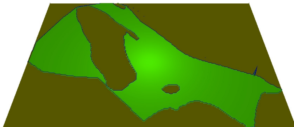
Slika 6.11 Debljina pokrivača na flišnom području u modelu za program LS-Rapid (zeleno područje s pokrivačem, smeđe područje vapnenaca i pješčenjaka na površini terena)
