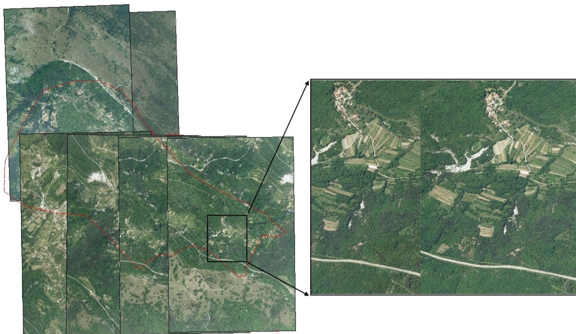
Slika 4.19 Aerofotogrametrijski snimci iz 2009. godine korišteni u izradi inventara klizišta s uvećanim dijelom područja na stereogramu
