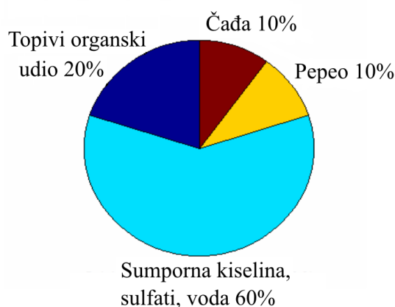
Slika 1.6: Primjer udjela sastojaka kod čestica iz ispušnih plinova sporohodnih dizelskih brodskih motora [4]
