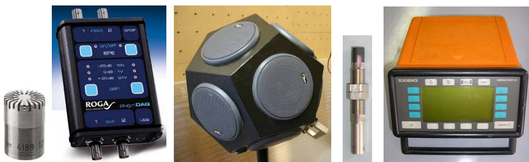
Slika 4.9. Mjerna oprema (redom: mikrofona, mjerna kartica, omnodirekcijski zvučnik, senzor za vibracije i mjerni uređaj Vibroport 41)
