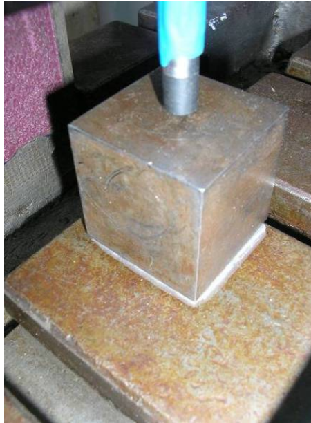
Slika 4.15. Prikaz mjerenja prigušenja u brtvi
