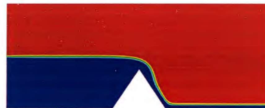
Slika 4.10. Distribucija faza (voda-zrak) u osi kanala
