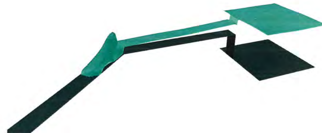
Slika 4.17. Prolazak poplavnog vala kroz pregib kanala ( t = 3 s) u 2D modelu
