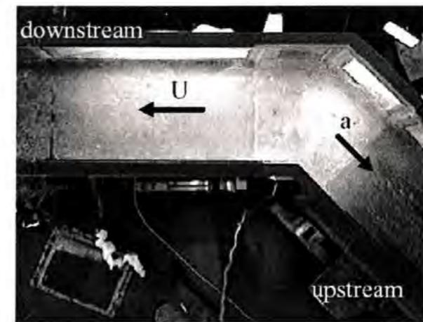
*Slika 4.14. Smjer strujanja vode (U) i smjer propagacije reflektiranog vala (a)*
