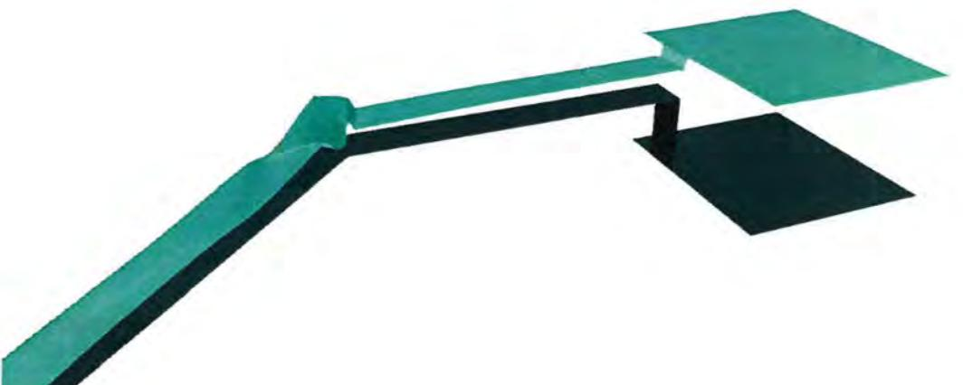
*Slika 4.18. Poplavljeno cijelo kanalo i formiranje povratnog vala (t = 5 s) u 2D modelu*
