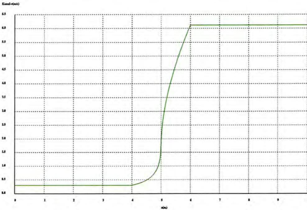
*Slika 4.3. Brzine strujanja dobivene 1D modelom plitkih voda*
