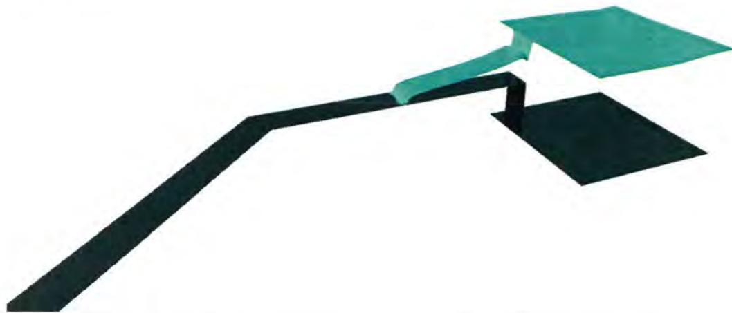
*Slika 4.16. Početak propagacije vodnog vala (t = 1 s) u 2D modelu*
