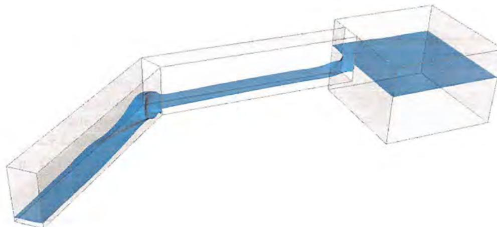
Slika 4.23. Poplavljeno cijelog kanala i formiranje povratnog vala ( $t = 5$  s) u 3D modelu
