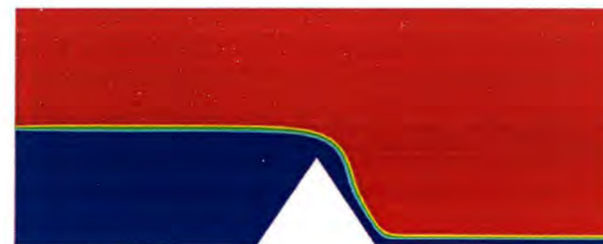
Slika 4.10. Distribucija faza (voda-zrak) u osi kanala
