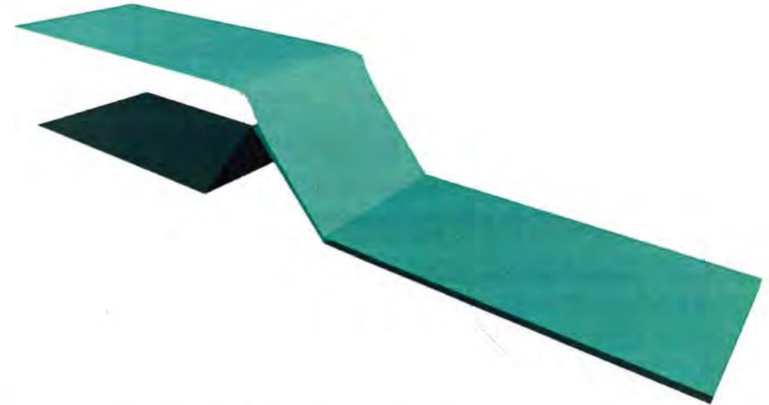
*Slika 4.4. Vodno lice dobiveno 2D modelom plitkih voda*
