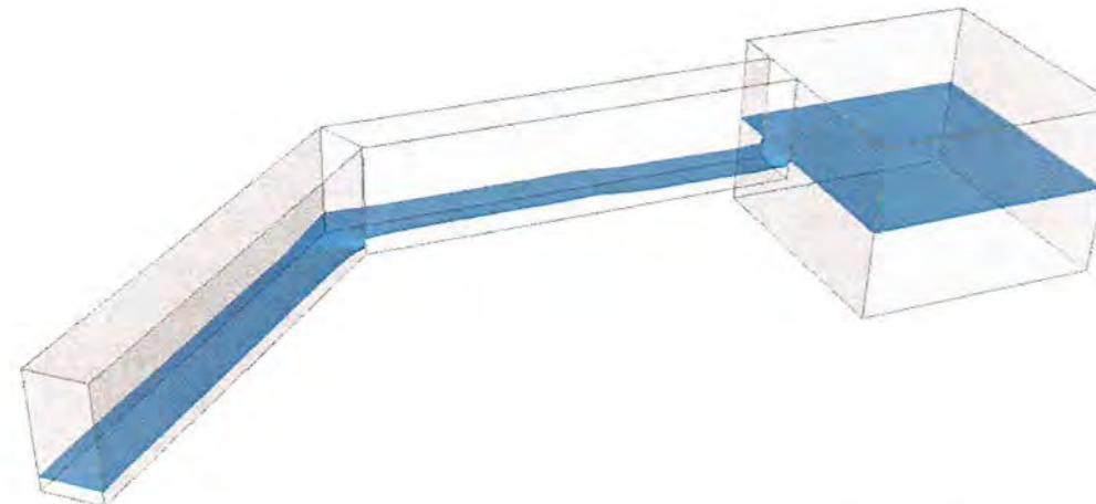
Slika 4.25. Izravnjanje vodnog lica ( $t = 20$  s) u 3D modelu
