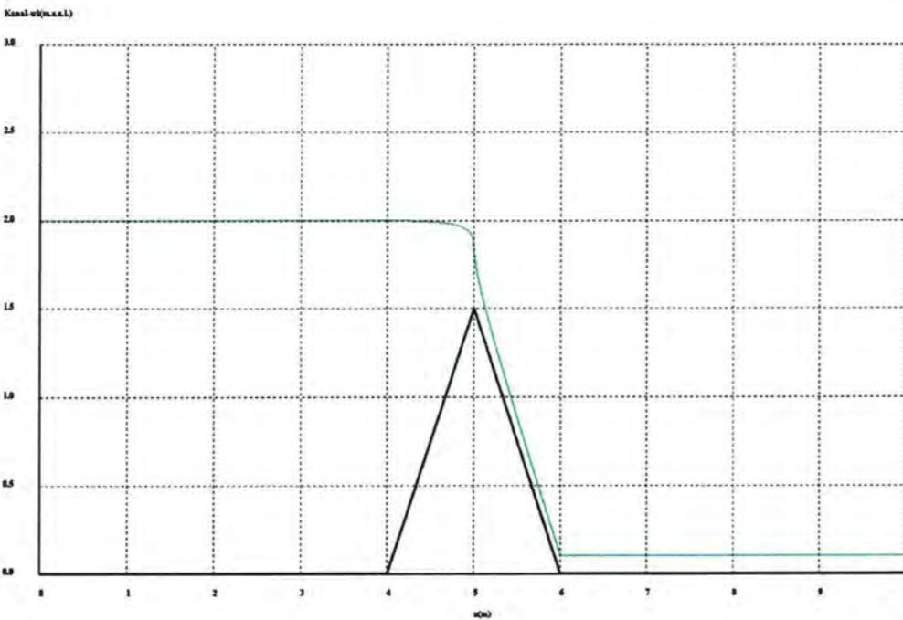
*Slika 4.2. Vodno lice dobiveno 1D modelom plitkih voda*
