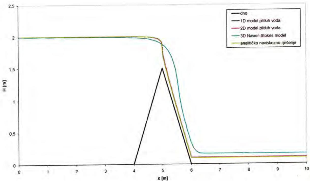
Slika 4.11. Usporedba proračunatih vodnih lica u osi kanala
