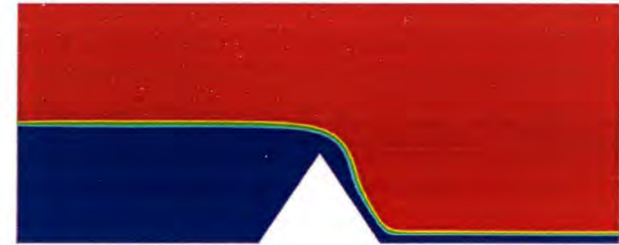
Slika 4.10. Distribucija faza (voda-zrak) u osi kanala
