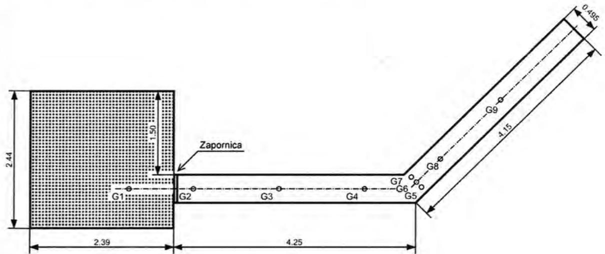
Slika 4.12. Izgled kanala s pregibom od  $45^\circ$
