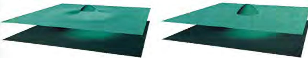
Slika 3.7. Proračunato vodno lice bez ispravnog balansiranja na unutarnjoj granici (lijevo) i sa ispravnim balansiranjem na unutarnjoj granici (desno)
