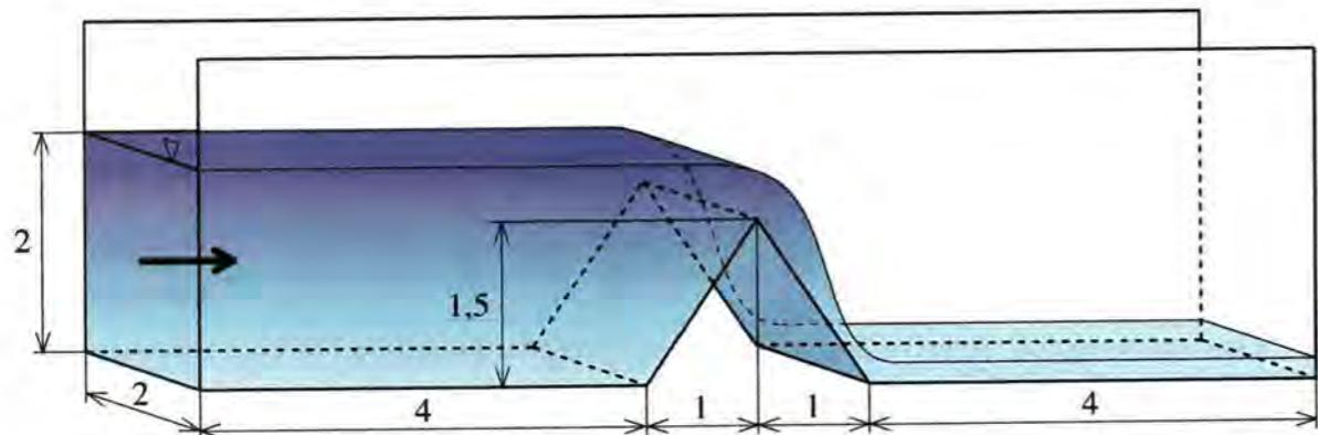
Slika 4.1. Test-primjer stacionarnog transkriticnog strujanja na preljevu
