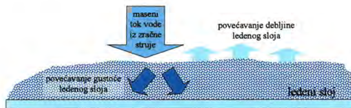
Slika 2.2. Shematski prikaz druge faze procesa nastanka ledenog sloja - period rasta ledenog sloja
