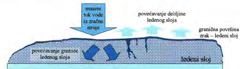
Slika 2.3. Shematski prikaz treće faze procesa nastanka ledenog sloja - period potpuno razvijenog rasta ledenog sloja
