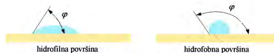
Slika 8.32. Prikaz dodirnog kuta hidrofilnih i hidrofobnih površina
