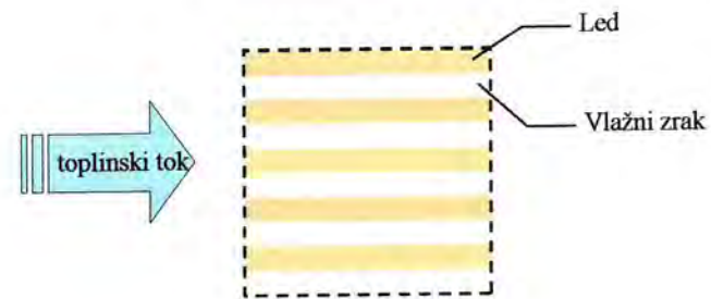
Slika 3.5. Shematski prikaz paralelnog modela za određivanje koeficijenta toplinske vodljivosti ledenog sloja
