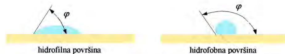
Slika 8.32. Prikaz dodirnog kuta hidrofilnih i hidrofobnih površina
