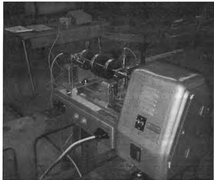
Sl. 8.1. Ispitivani rotor sa mjernom opremom
