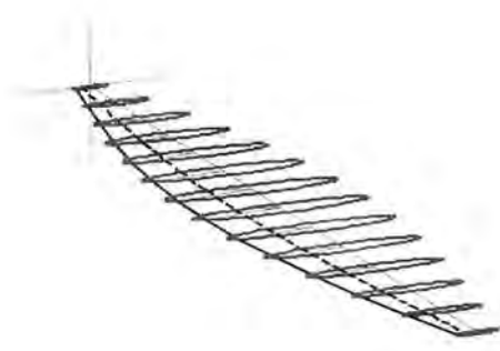
SI.7.5. Orbite i fleksijski oblici pri \omega=379.1 \text{ rads}^{-1}
