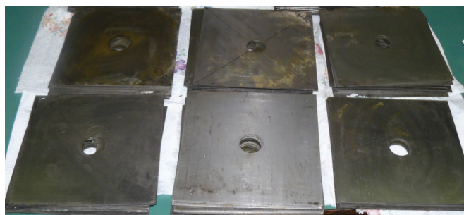
Slika 5.18 Pripremljene podložne ploče, materijal DC01 debljine 1 mm
