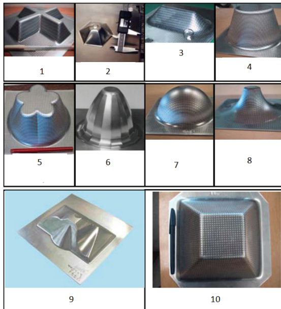
Slika 2.16 Vrste ispitnih uzoraka upotrebljavanih za izradu dijagrama sposobnosti oblikovanja u SPIF procesu [6]
