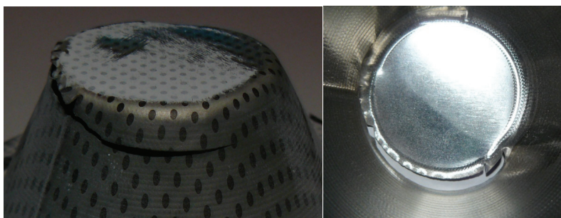
Slika 10.18 Pukotina materijala TH415 nastala pri visini od 33 mm
