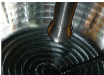
Slika 8.6 Alat nakon izvršene SPIF obrade
