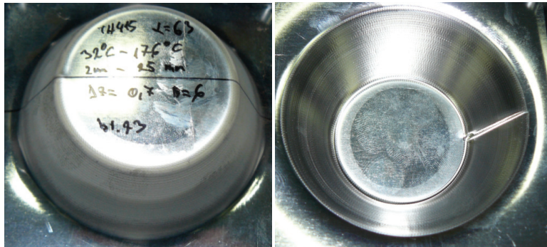
Slika 8.13 Prikaz izratka kut 63^\circ , lim TH415
