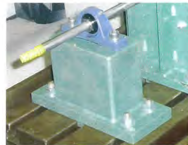
Slika 5.5. Ležajni blok sa samopodesivim kugličnim ležajem
