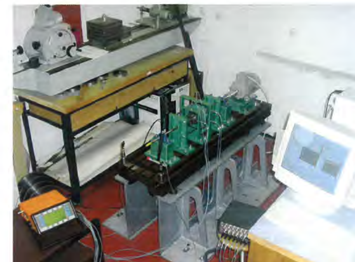
Slika 5.2. Fotografija eksperimentalnog uređaja za istraživanje dinamike rotora
