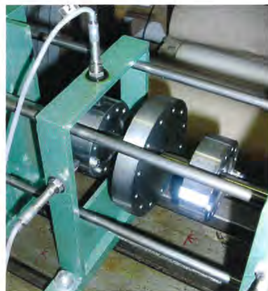
Slika 5.4. Raspored diskova na osovinu
