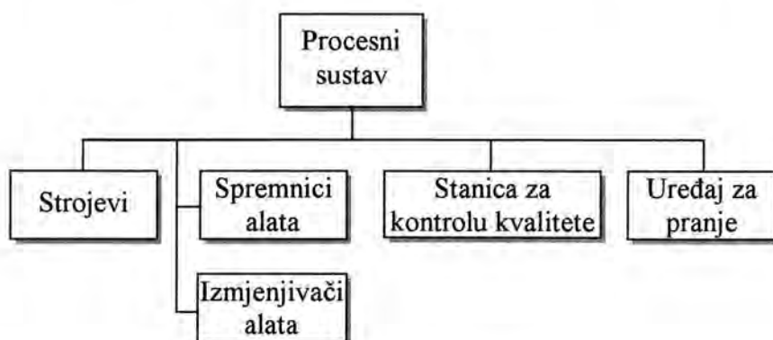
Sl. 2.11 Komponente procesnog sustava FPS-a
