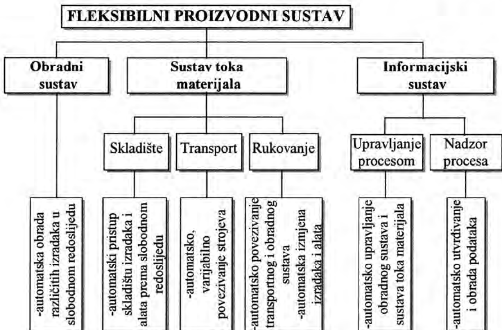
Sl. 2.8 Struktura i karakteristike FPS-a
