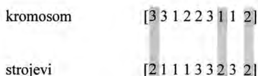
Sl. 4.7 Redoslijed izrade dijelova na stroju m_2 ; (prikazan osjenčano)
