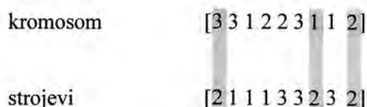
Sl. 4.7 Redoslijed izrade dijelova na stroju m_2 ; (prikazan osjenčano)
