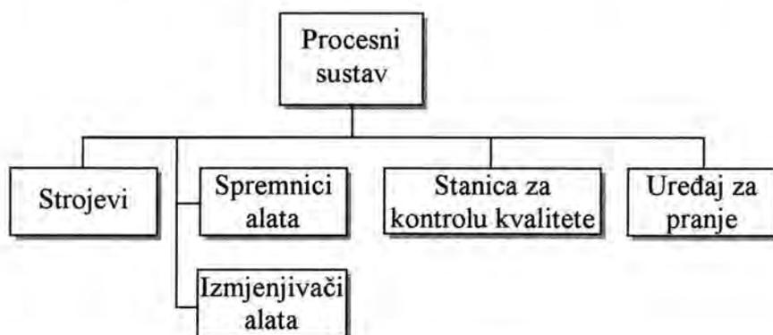
Sl. 2.11 Komponente procesnog sustava FPS-a
