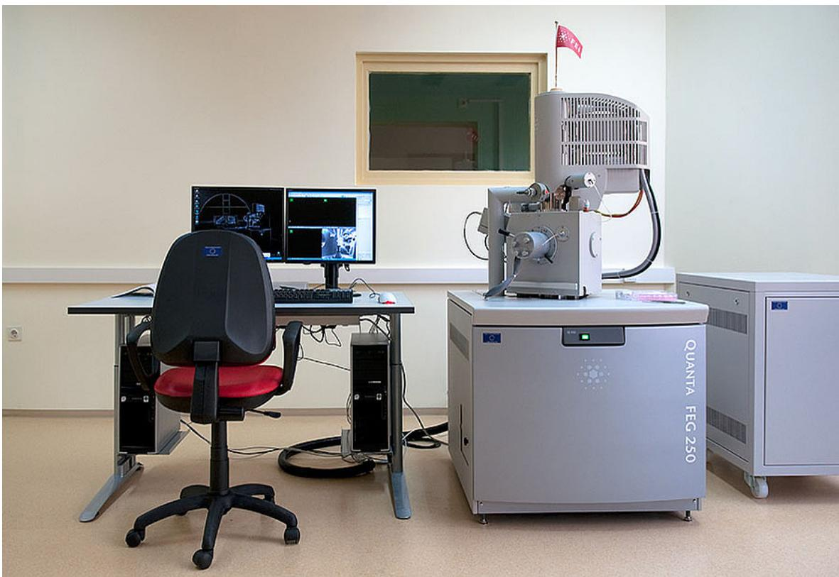
**Slika 17.** Skenirajući elektronski mikroskop (SEM) QUANTA 250 FEI
