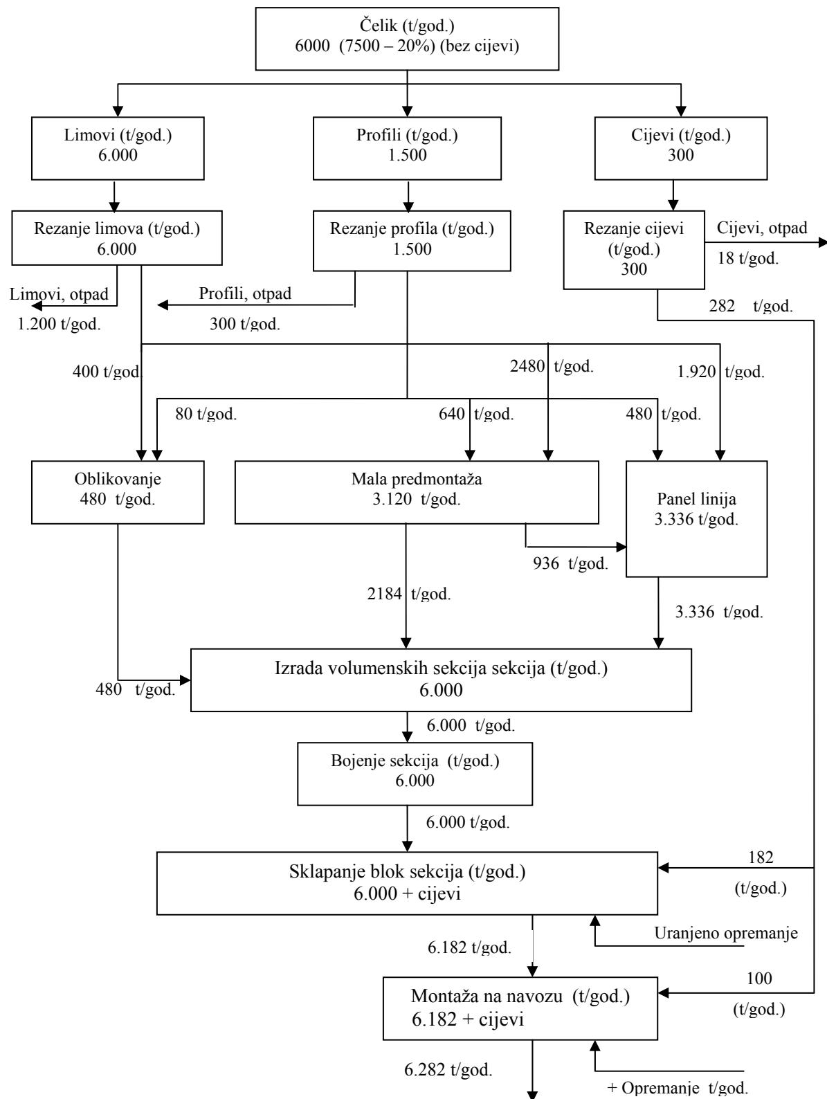
Slika 5.1.2. Shematski prikaz osnovnog brodograđevnog proizvodnog procesa
