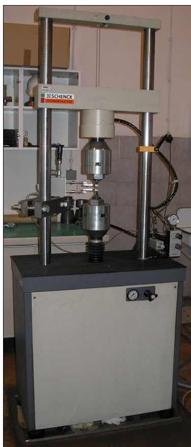
Slika 4.2 Univerzalni servo-hidraulički ispitni stroj Schenck Hydropuls PSA
