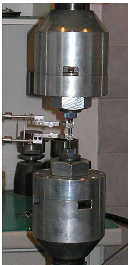
Slika 4.2 Univerzalni servo-hidraulički ispitni stroj Schenck Hydropuls PSA
