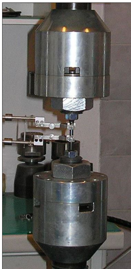
Slika 4.2 Univerzalni servo-hidraulički ispitni stroj Schenck Hydropuls PSA
