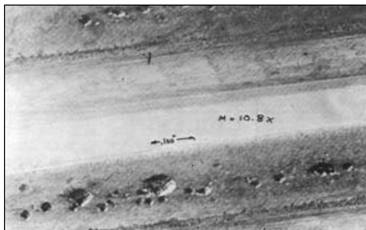
Slika 3.2 Jamičenje na bokovima zuba [39]
