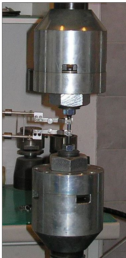
Slika 4.2 Univerzalni servo-hidraulički ispitni stroj Schenck Hydropuls PSA
