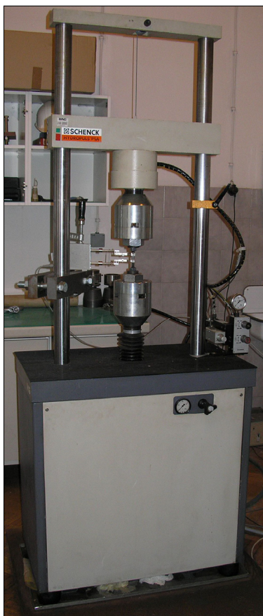
Slika 4.2 Univerzalni servo-hidraulički ispitni stroj Schenck Hydropuls PSA
