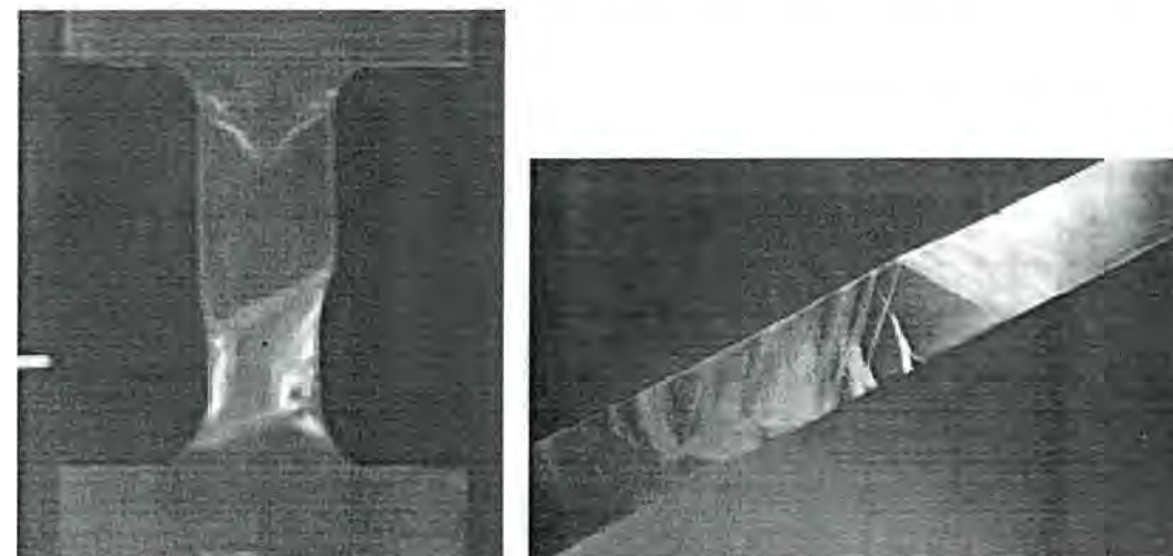
Sl. 8.33. Pojava Lüderovih traka pri aksijalnom opterećenju epruvete, Schey [110, str. 258]
