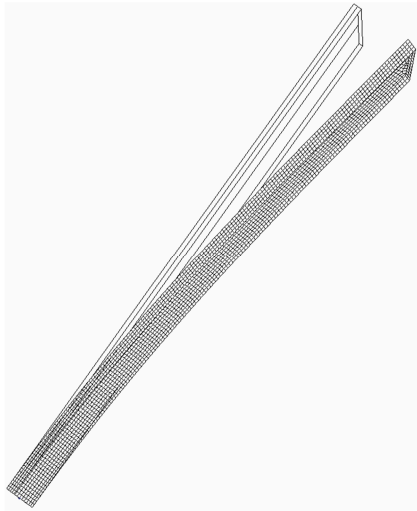
sl. 5.26. Prvi mod izvijanja ukliještenog pravokutnog okvira
