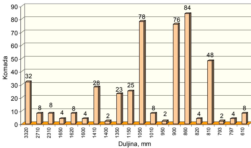
Slika 53. Specifikacija duljina za tip profila TR150x13
