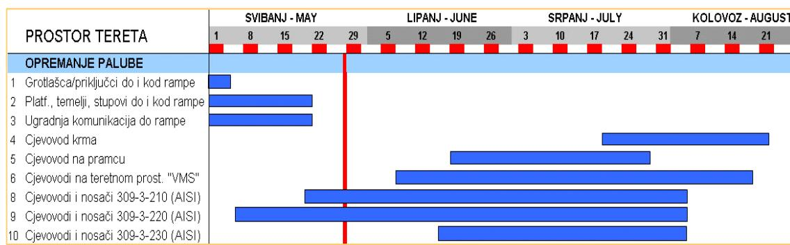
Slika 11. Gantogram poslova opremanja dijela palube novogradnje, [65]
