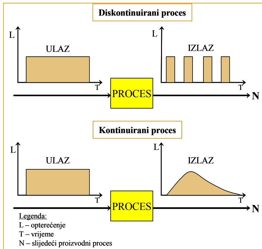
**Slika 10.** Prikaz diskontinuiranog i kontinuiranog opterećenja proizvodnog procesa
