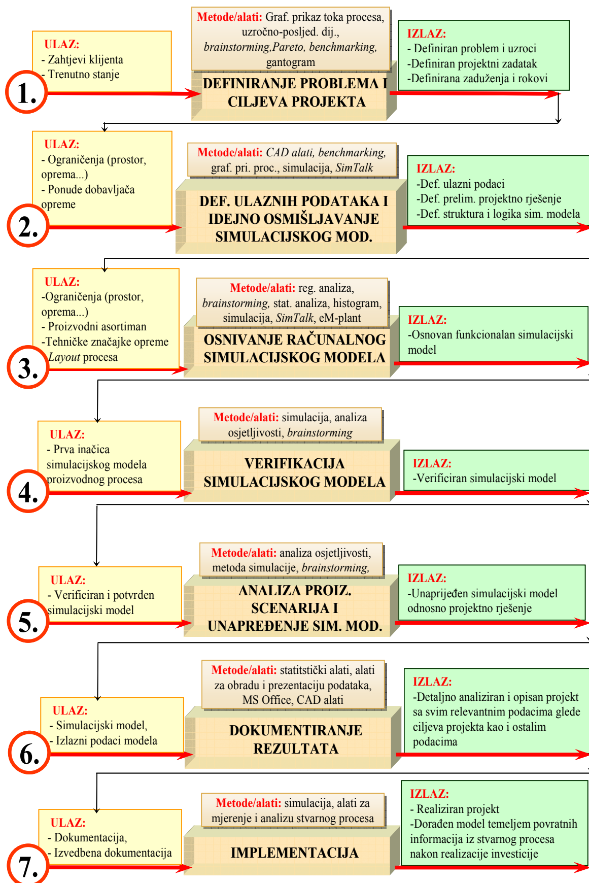
Slika 50. Osnovna struktura predložene metodologije projektiranja brodograđevnog procesa
