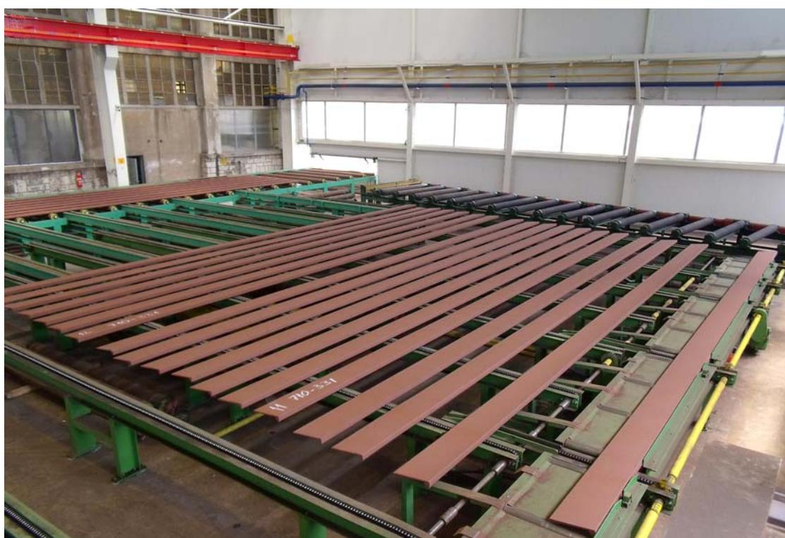
**Slika P5.2** Prikaz dijela linije na kojoj se vide bankate profila na ulaznom međuskladištu prije pojedinačnog prelaska na uzdužni valjčasti transporter
