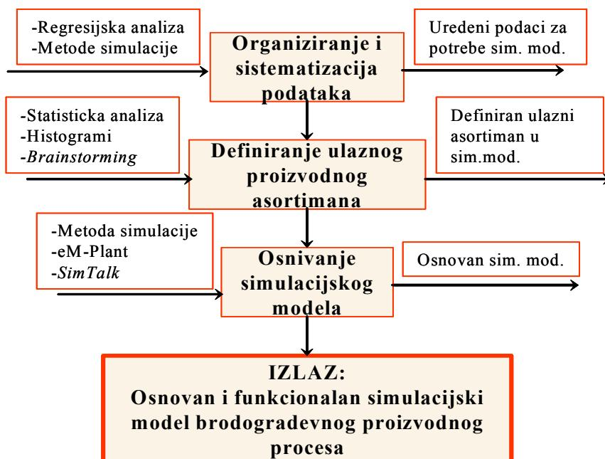
**Slika 34.** Struktura, metode i alati faze osnivanja računalnog simulacijskog modela brodograđevnog proizvodnog procesa
