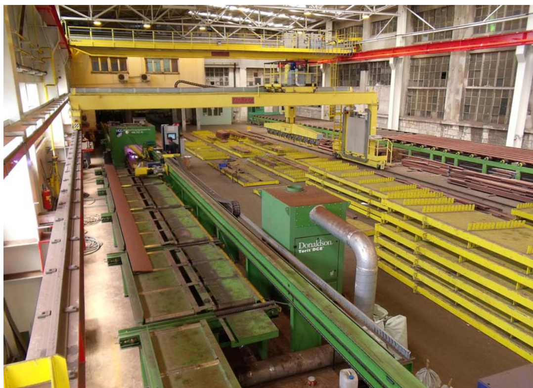
Slika P5.4 Prikaz dijela linije na kojoj se vidi izlazni transporter iz stanice za sušenje i čišćenje rubova profila, robotska stanica za rezanje profila, palete za sortiranje profila i sortirna dizalica
