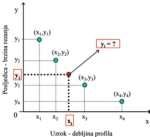
**Slika 48.** Parovi rezultata ovisnosti brzine rezanja o debljini profila prikazani kao točke u koordinatnom sustavu
