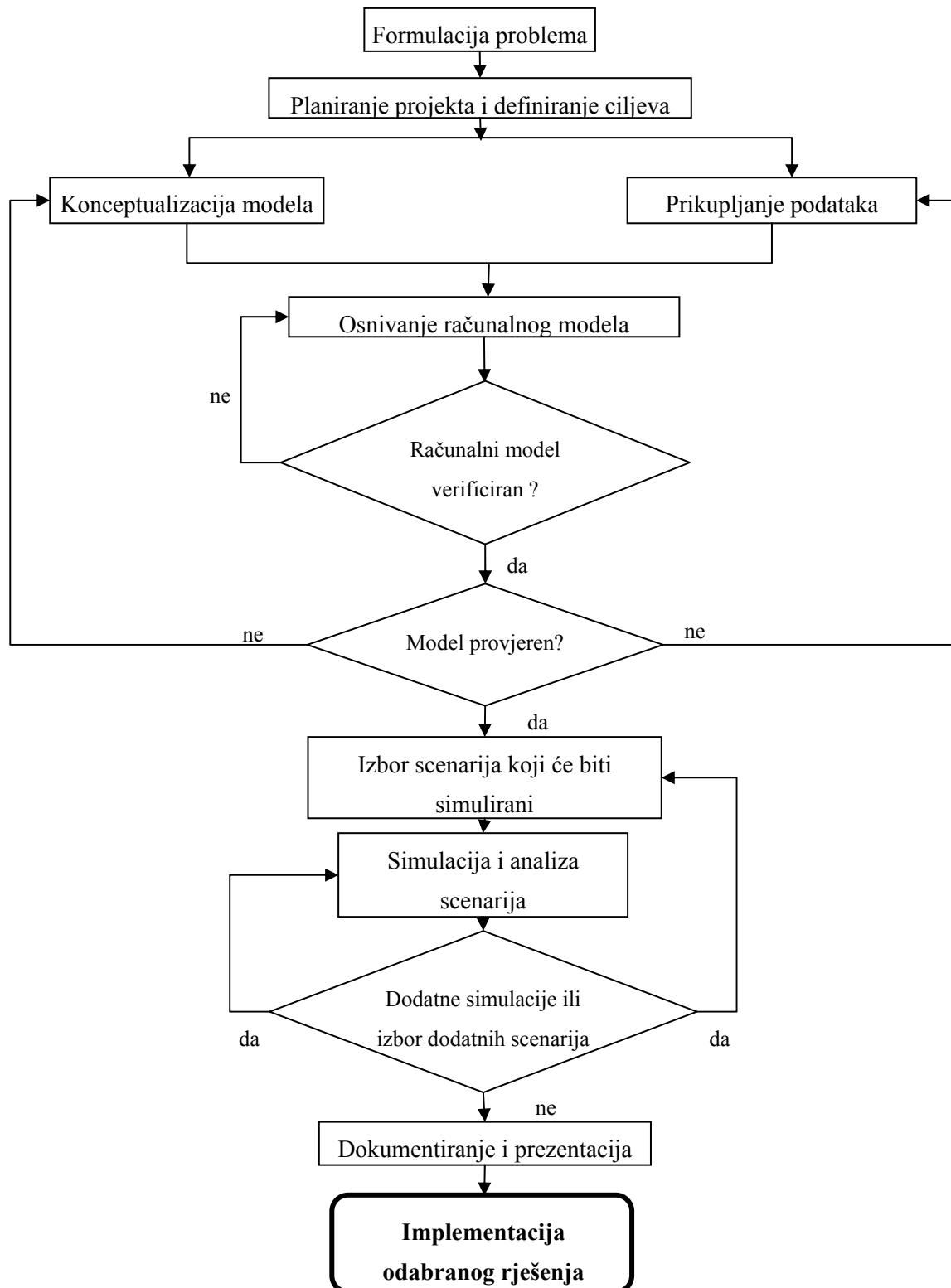
Slika 17. Koraci u postupku simulacijskog modeliranja
