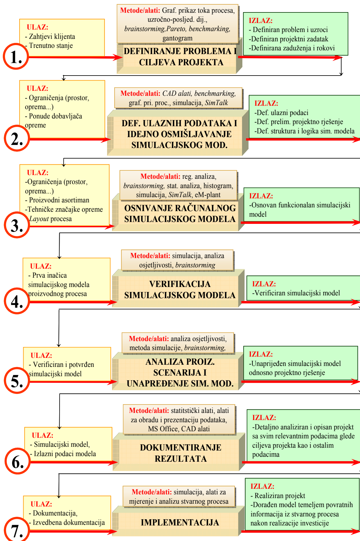
Slika 50. Osnovna struktura predložene metodologije projektiranja brodograđevnog procesa
