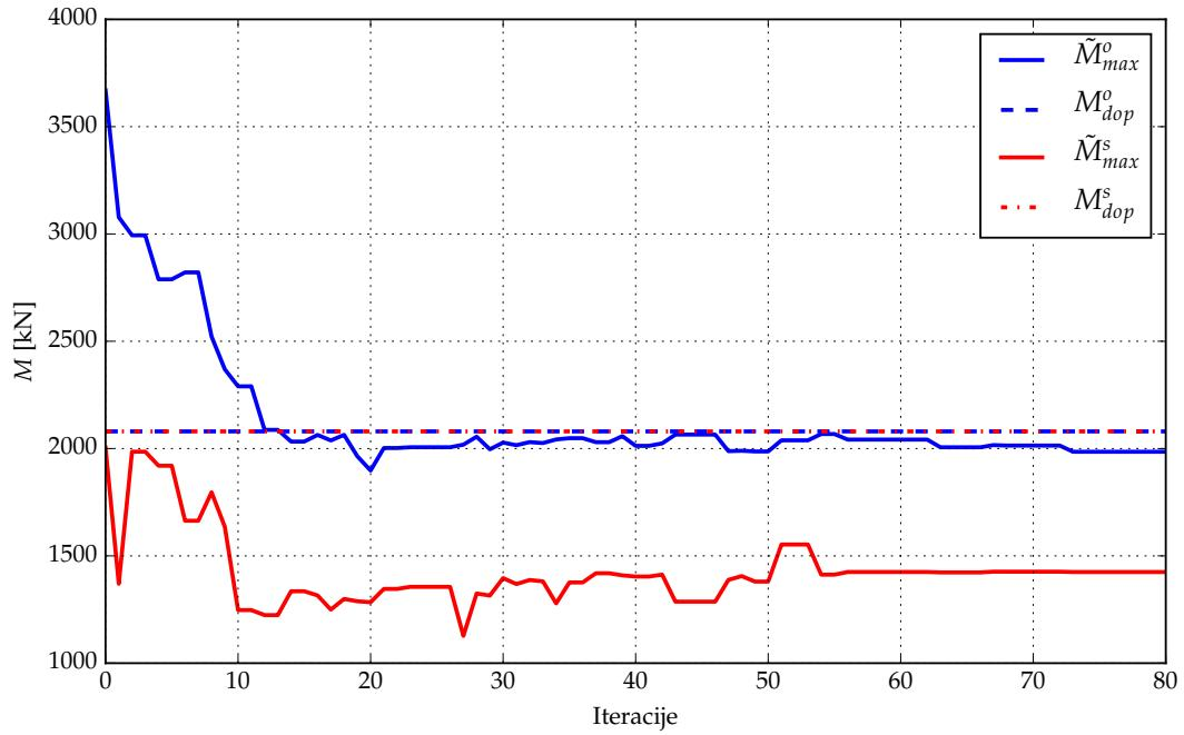
Slika 6.14: Primjer C: Maksimalni apsolutni moment savijanja u području *overbenda* i *sagbenda*
