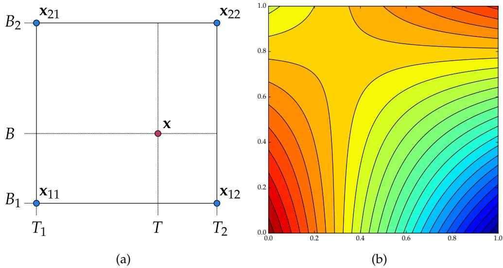
Slika 5.6: Bilinearna interpolacija: (a) crvena točka  $\mathbf{x}$  određena je kontinuiranom silom napinjanja  $T$  i uzorkom uzgonskih tankova  $B$ , dok su plave točke definirane najbližim diskretiziranim vrijednostima sile napetosti i uzorka uzgonskih tankova, (b) primjer bilinearne interpolacije za poznate vrijednosti  $f(0,0) = 2$ ,  $f(0,1) = 1.7$ ,  $f(1,0) = 1.2$  i  $f(1,1) = 1.9$
