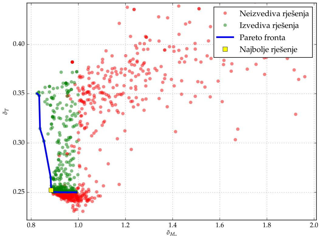
Slika 6.6: Primjer A: Pareto fronta za  $\check{\sigma}_{M_o}$  i  $\check{\sigma}_T$
