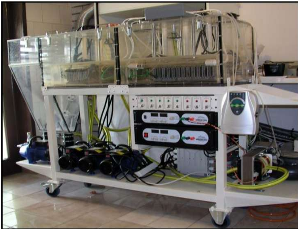
Slika 3.22 Pilot-postrojenje za obradu pitke vode kombinacijom elektrokemijskih metoda i naprednih oksidacijskih procesa
