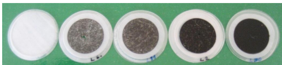
Slika 5.13. Fotografija teflonskog filtra i uzoraka aerosola prikupljenih u Trpimirovoj ulici od 24. 2. 2012. do 4. 3. 2012. godine. Prikazane su različite koncentracije crnog ugljika na teflonskim filtrima.
