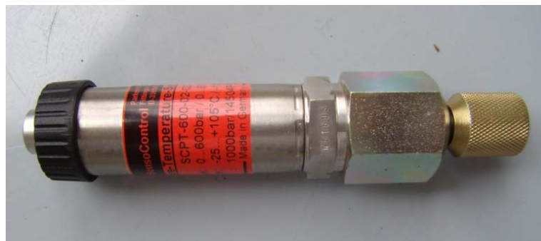
Slika 5.8. Mjerni osjetnik tlaka i temperature SCPT 600-02-20
