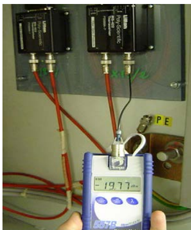
Slika 65: Mjerenje snage svjetlosnog signala
