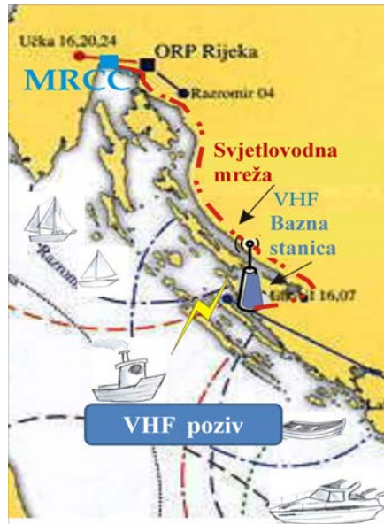
Slika 14: Povezivanje VHF radio-signala na svjetlovodnu mrežu
