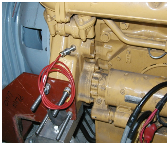
Slika 42: Induktivni senzor za mjerenje okretaja motora
