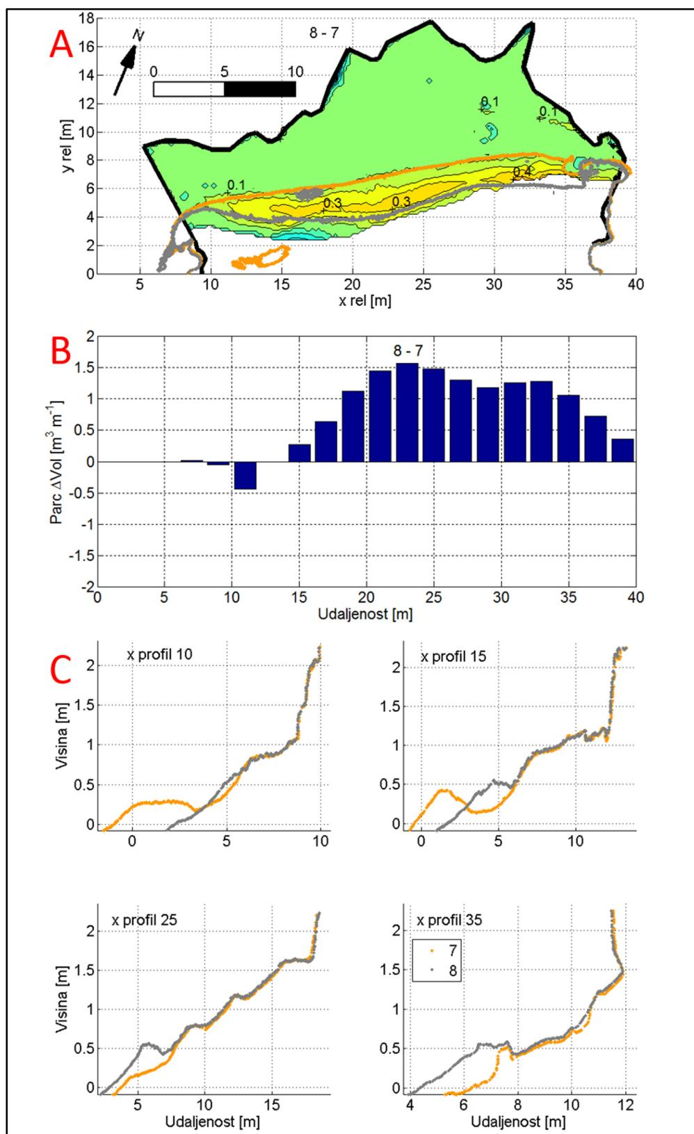
Slika 6.24. Promjene žala Klančac između mjerena 7 (4.12) i 8 (24.12) A - promjene visina žala; B - parcijalne promjene volumena žala izražene po metru dužnom žala; C - poprečni presjeci žala
