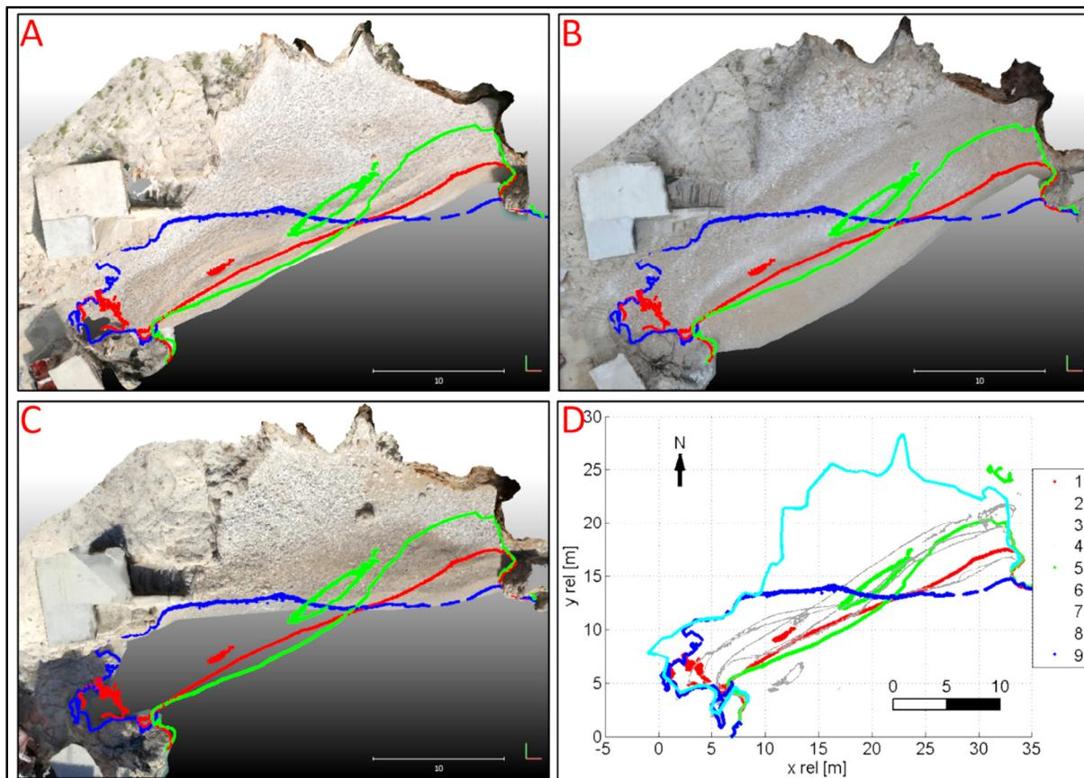
**Slika 6.6. Promjene obalne linije i rotacija žala Klančac (Brseč) prikazane na foto-realističnom oblakom točaka žala i slojnicom žala visine 0.40 m n.m.**
