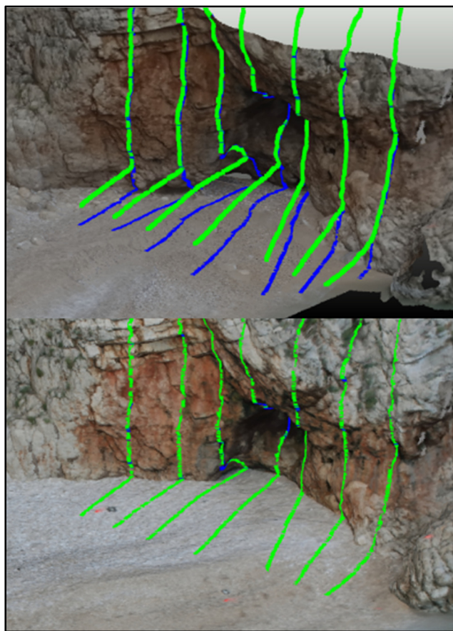
Slika 5.15. Primjer promjena složenog profila žala prikazan trodimenzionalnim oblakom točaka.
