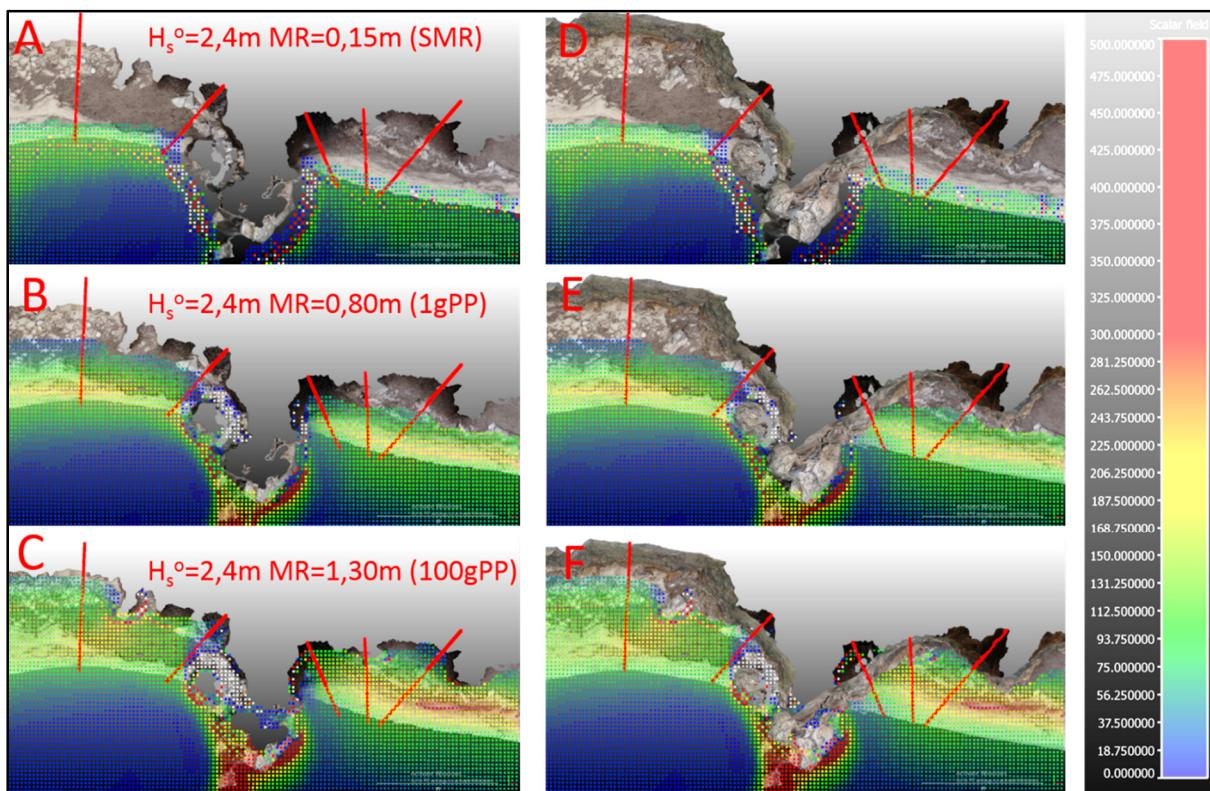
Slika 8.8. Rezultati numeričke simulacije disipacije energije valova prikazane na foto-realističnom 3D oblaku točaka. A-C - originalni oblak točaka; D-F - oblak točaka reduciran do visine 1,30 m n.m.
