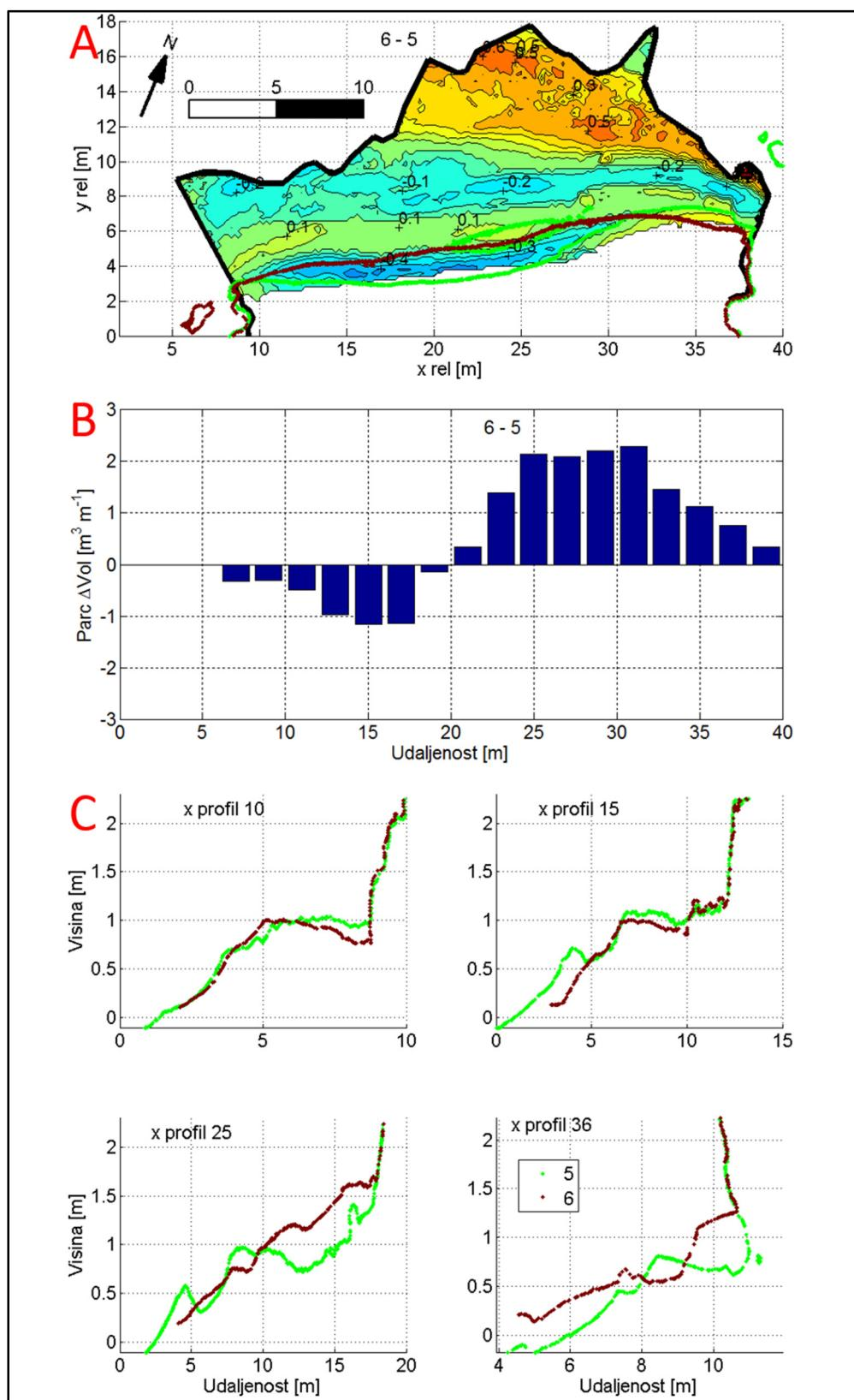
Slika 6.20. Promjene žala Klančac između mjerjenja br. 5 (18.11.) i 6 (28.11.). A - promjene visina žala; B - parcijalne promjene volumena žala; C - poprečni presjeci žala
