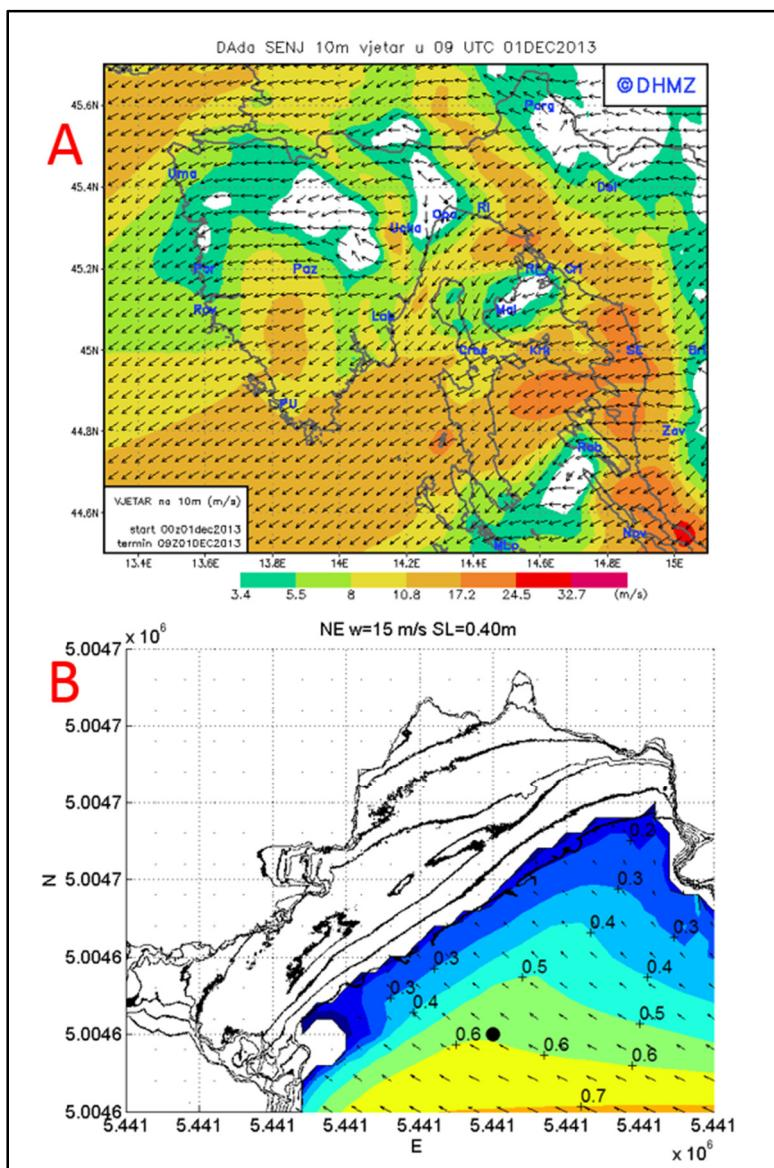
**Slika 6.21. Polje vjetra prognozirano modelom Aladin (A - 1.12). Rezultati numeričke simulacije značajne visine vala (SWAN) ispred žala Klančac sa prikazanim slojnicama mjerena 6 i 7 (raspored slojnica detaljno je prikazan na slici 3).**
