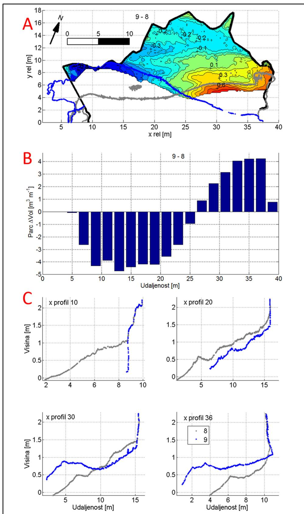
Slika 6.27. Promjene žala Klančac između mjerena 8 (24.12.) i 9 (27.12.). A - promjene visina žala; B - parcijalne promjene volumena žala; C - poprečni presjeci žala
