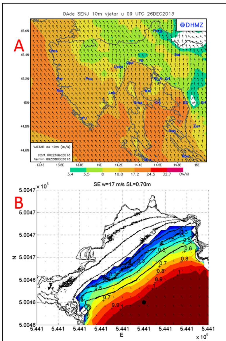
**Slika 6.26 Polje vjetra prognozirano modelom Aladin (26.12). Rezultati numeričke simulacije značajne visine vala (SWAN) ispred žala Klančac sa prikazanim slojnicama mjerena 8(24.12)**
