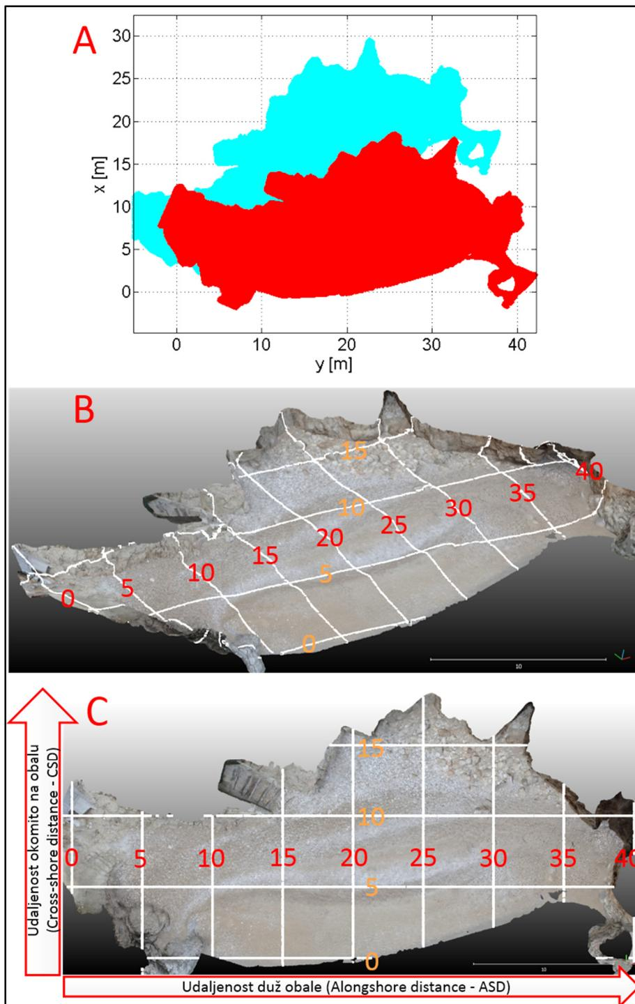
Slika 6.1. A - Oblak točaka žala prikazan u relativnom koordinatnom sustavu s ishodištem u točci E 322710, N 5007320, H 0, HTRS96 (svjetlo plava) i relativnom rotiranom koordinatnom sustavu (crvena) s kutom rotacije 23,7°; B – 3D prikaz oblaka točaka sa karakterističnim udaljenostima; C – Prikaz udaljenosti duž obale (*long-shore*) i okomito na obalu (*cross-shore*) žala
