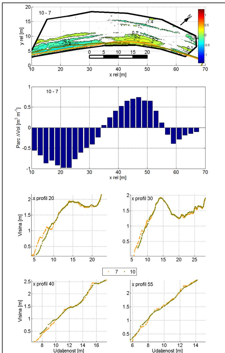
Slika 7.9. Promjene žala Uboka između mjerjenja 7 (14.2.) i 10 (11.4.). A - promjene visina žala; B - parcijalne promjene volumena žala; C – poprečni presjeci žala.
