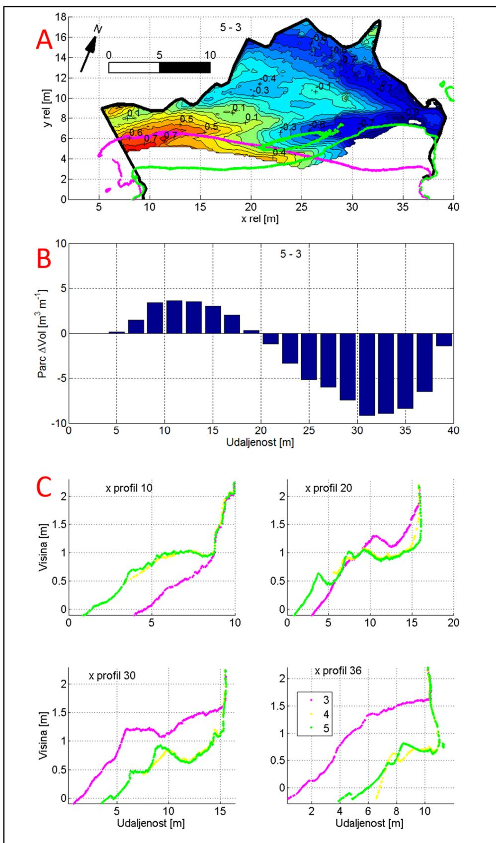
Slika 6.18. Promjene žala Klančac između mjerjenja 3 (6.11.), 4 (12.11.) i 5 (18.11.). A - promjene visina žala; B - parcijalne promjene volumena žala; C - poprečni presjeci žala
