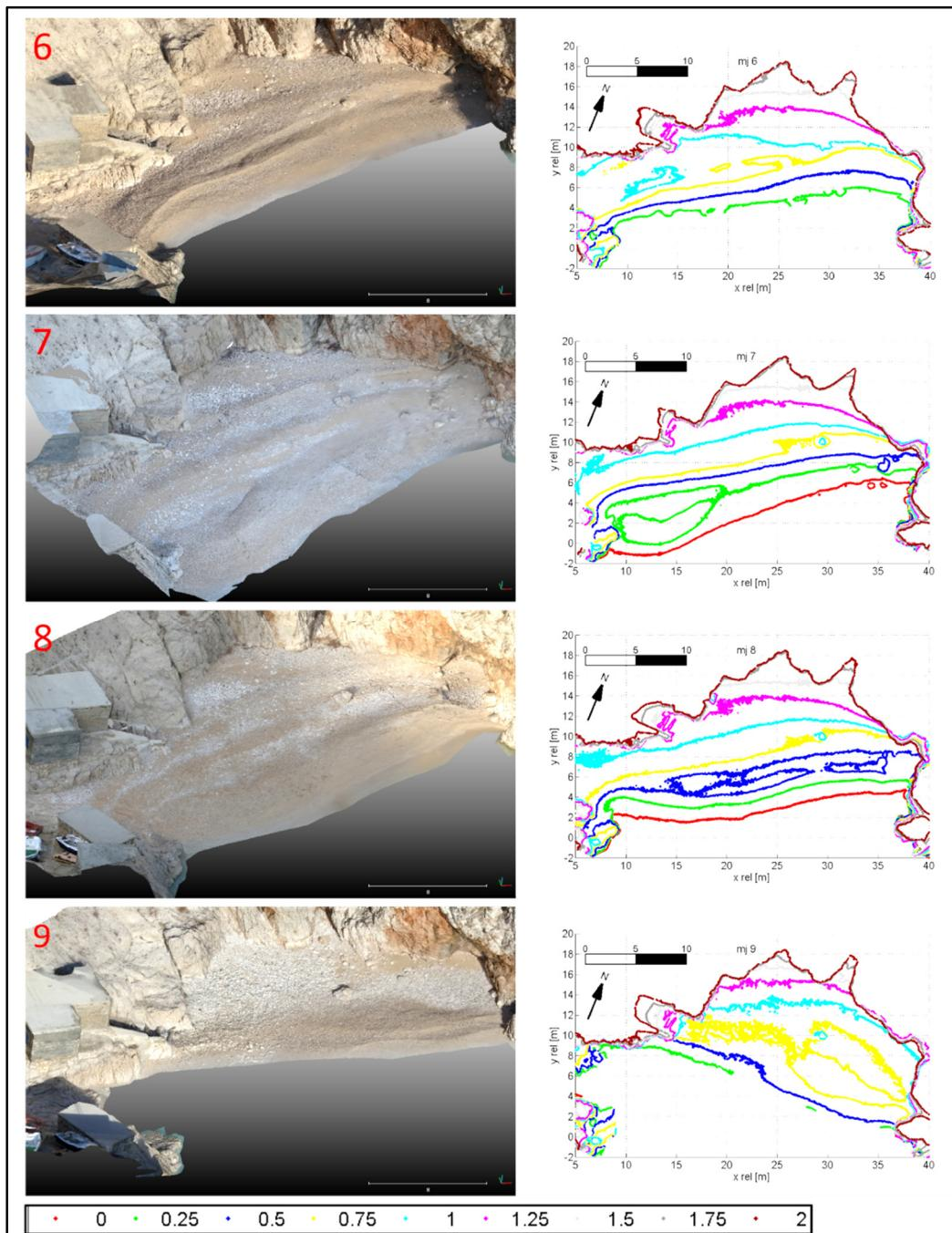
**Slika 6.3. Trodimenzionalni foto-realistični oblak točaka i slojnice derivirane iz oblaka točaka žala Klančac. Mjerena: 6 (28.11.), 7 (4.12.), 8 (24.12.) i 9 (27.12.).**
