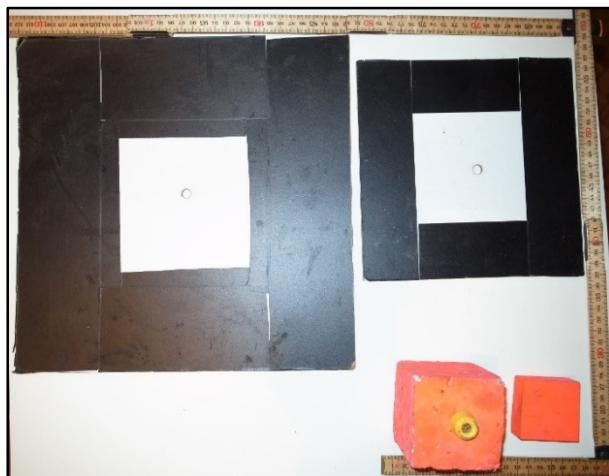
Slika 5.4. Primjer korištenih zemaljskih kontrolnih točaka (*ground-control-points (GCP)*)
