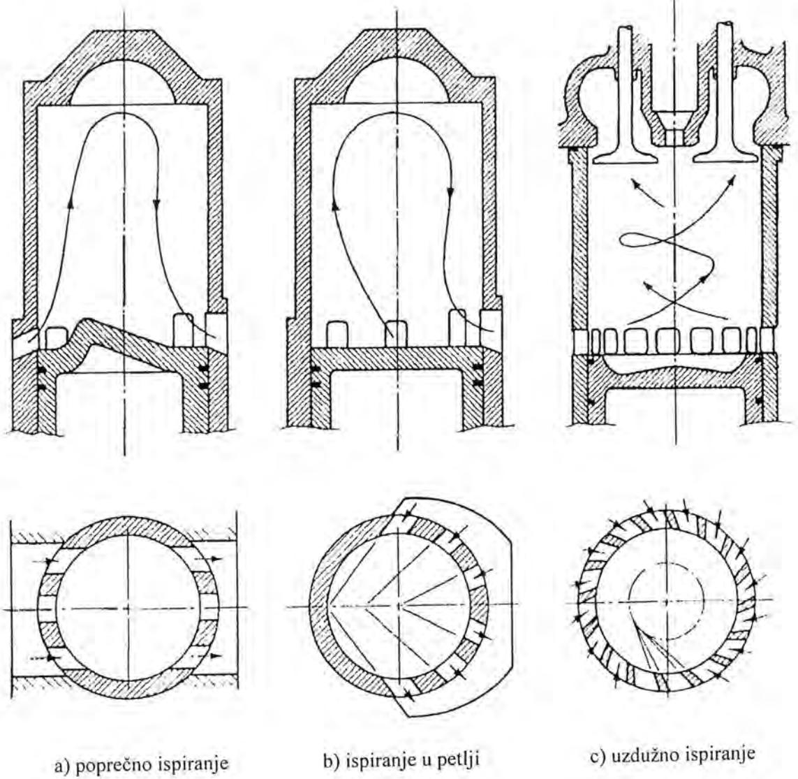
Sl. 3.4 Načini ispiranja cilindra dvotaktnog motora
