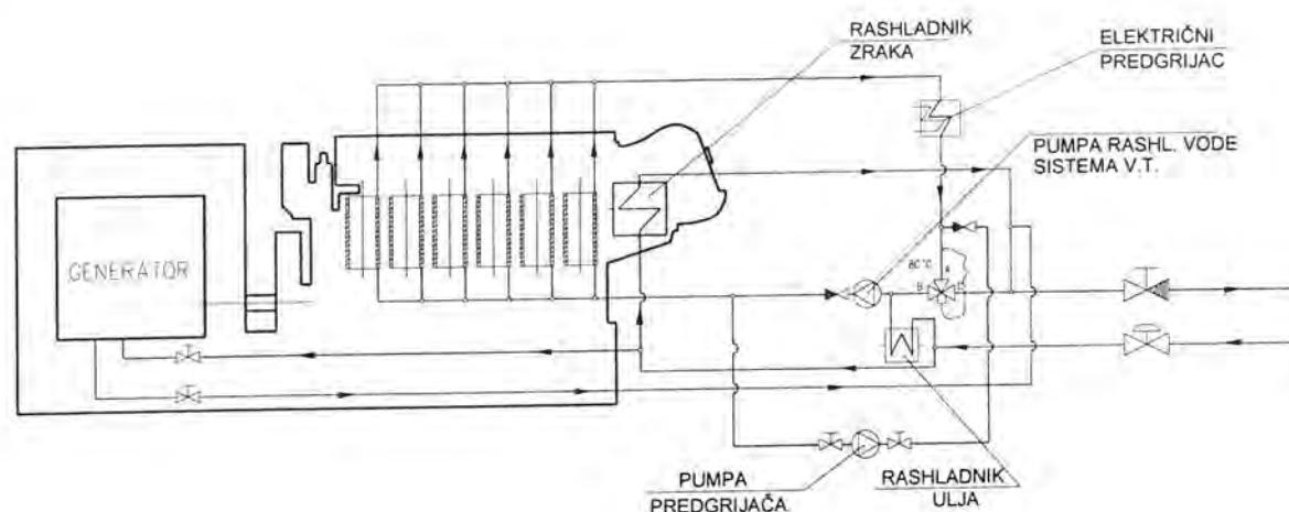
Sl. 5.13 Rashladni sistem pomoćnog motora MAN L23/30
