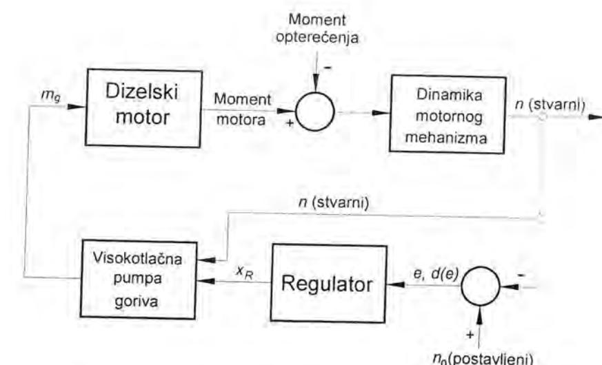
Sl. 3.17 Shema regulacije brzine vrtnje dizelskog motora
