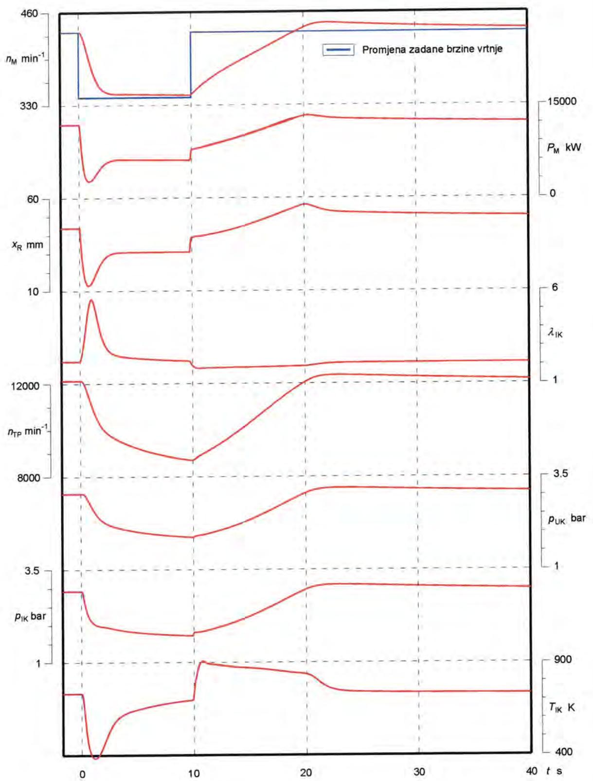
Sl. 4.10 Promjena značajki motora mijenjanjem brzine vrtnje
