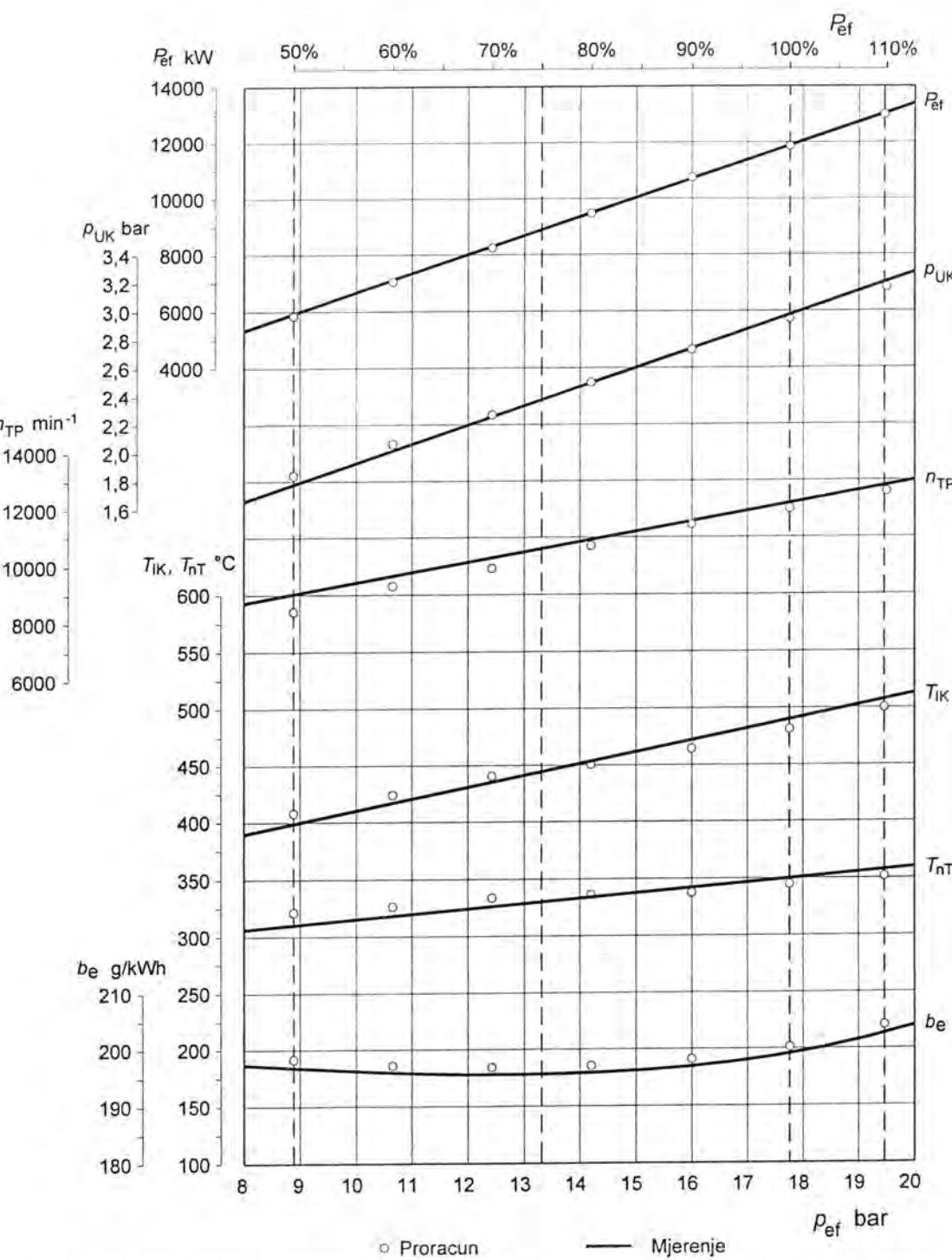
Sl. 4.8 Usporedba izmjerljenih vrijednosti i rezultata simulacije za stacionarni rad dizelskog motora pri nominalnoj brzini vrtnje
