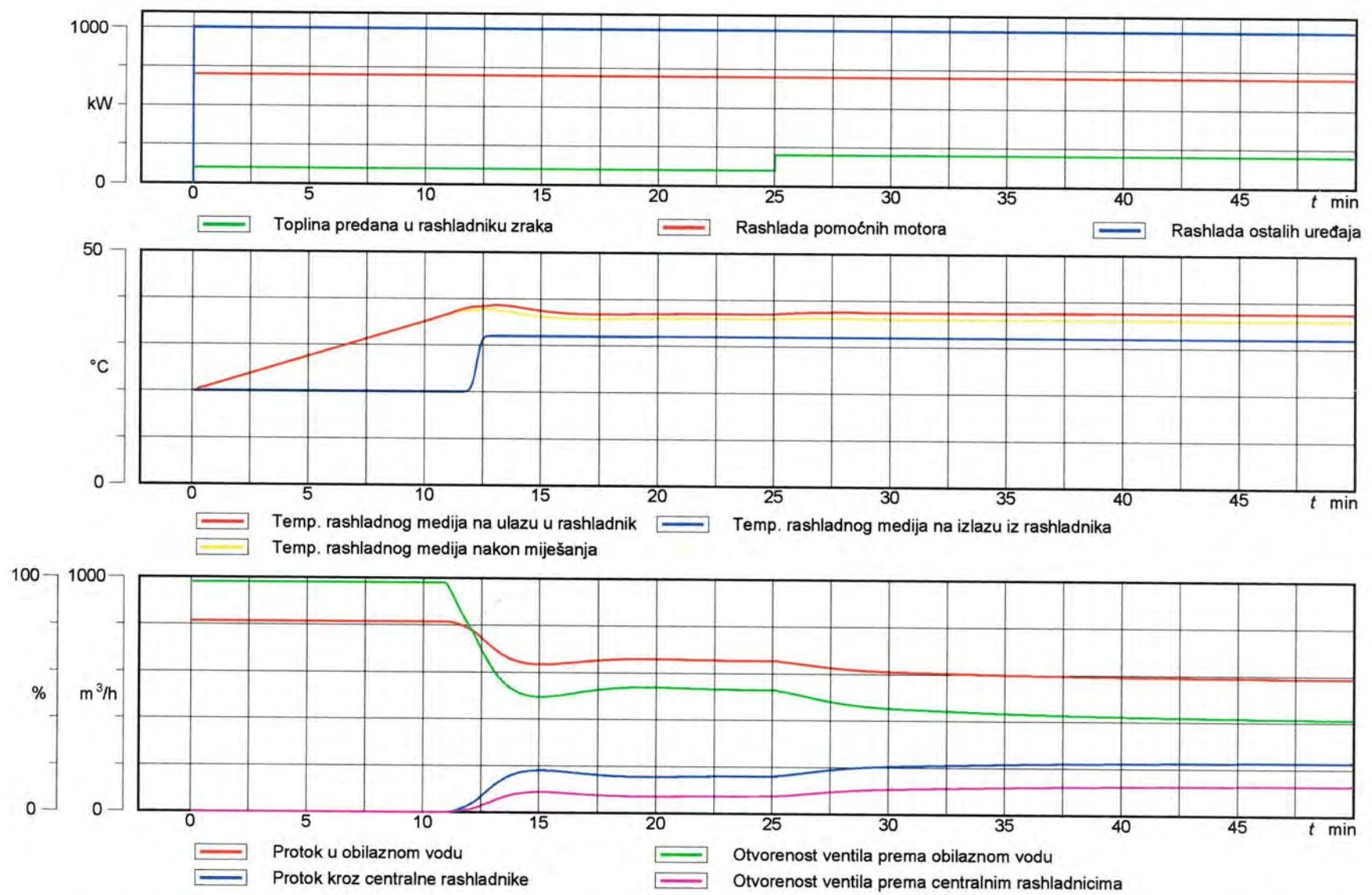
SI. 6.11 Simulacija rada rashladnog sistema uz opterećenje glavnog motora od 25% nazivne snage (NT krug rashlade, morska voda 32°C)
