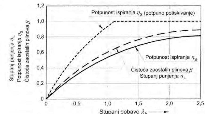
Sl. 3.8 Promjena potpunitosti ispiranja, stupnja punjenja i stupnja čistoće plinova u ovisnosti o stupnju dobave
