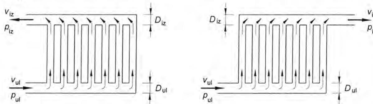
Sl. 5.8 Mogući načini priključivanja pločastih izmjenjivača topline
