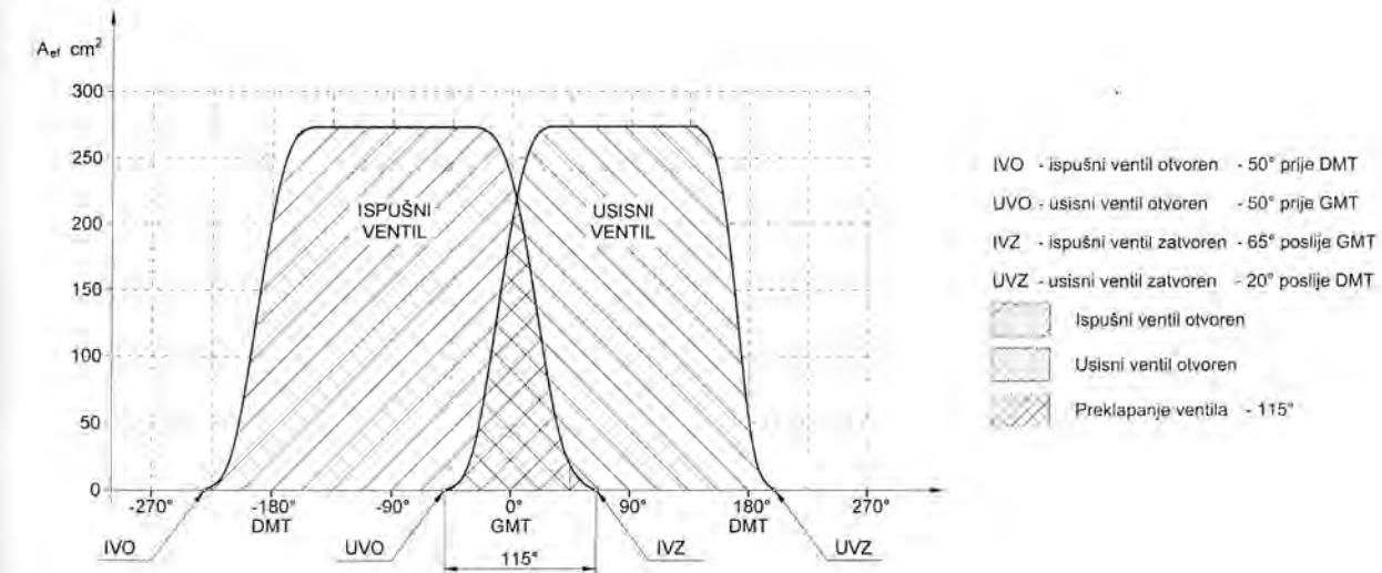
Sl. 4.3 Dijagram otvaranja i zatvaranja usisnih i ispušnih ventila
