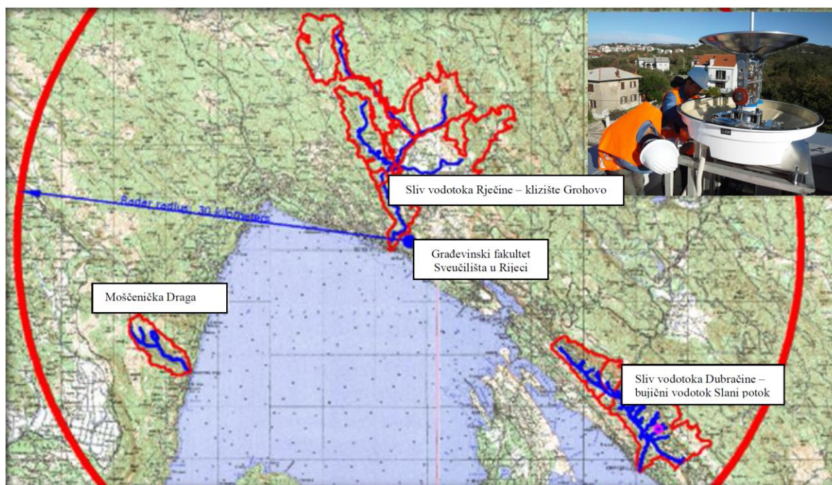
Slika 2.28. Instalacija Furuno X-Band Dual polarimetrijskog Doplerova radara i njegova primjena za tri karakteristična odabrana pilot područja unutar hrvatsko-japanskog bilateralnog znanstvenog projekta
