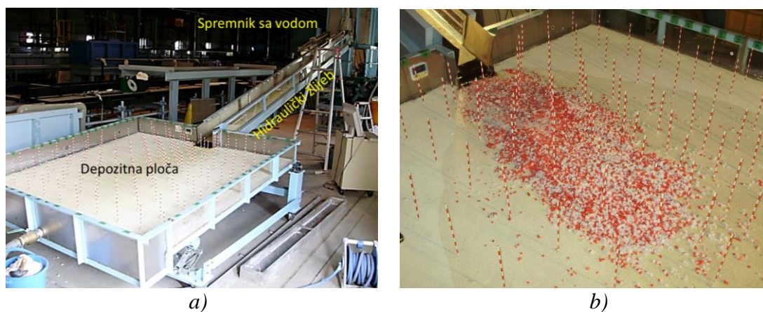
Slika 4.3. a) Osnovni dijelovi fizikalnog modela toka krupnozrnatog materijala, b) deponirani krupnozrnati material, (Ujigawa Open Laboratory), Sveučilište u Kyotu (Žic i sur., 2013a)
