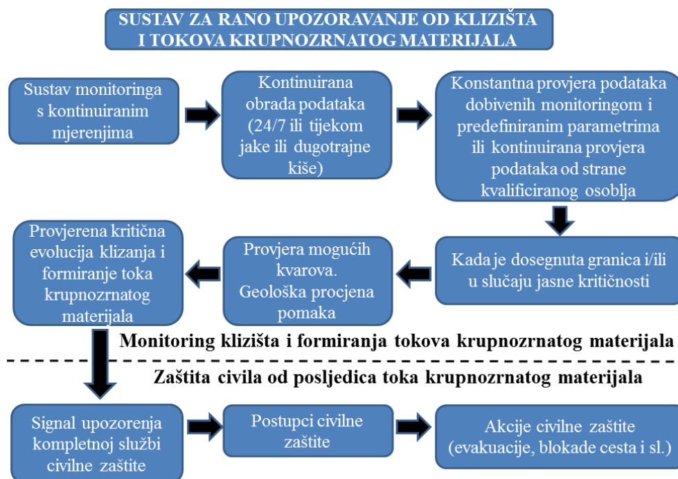
Slika 7.6. Predloženi opći tok aktivnosti sustava za rano uzbunjivanje od pojave hazarda klizišta i formiranja krupnozrnatog toka na području srednjeg i donjeg toka Rječine (modificirano prema ClimChAlp, 2008.)
