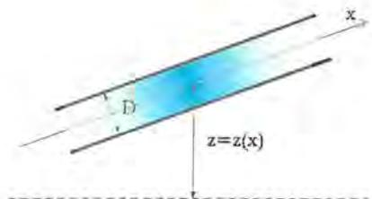
Sl. 1. Jednodimenzionalno strujanje u cijevi
