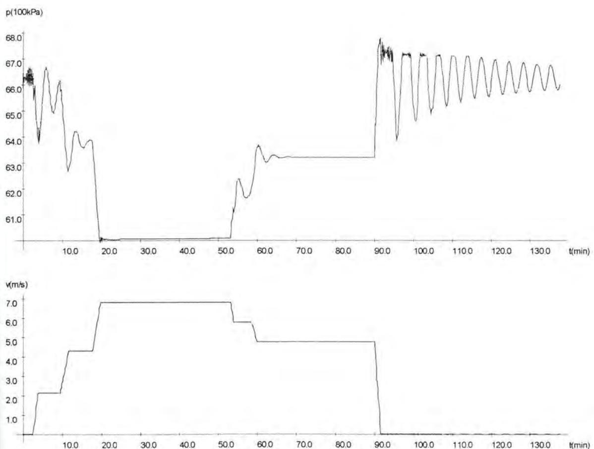
Sl. 41. Proračun 3.4 – tlak i brzina kod turbina
