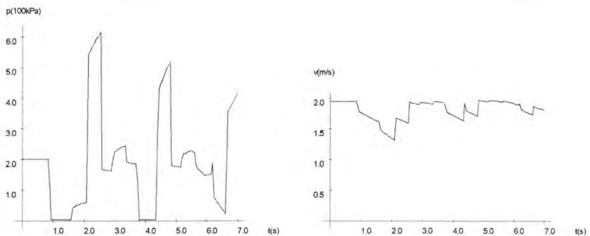
Sl. 48.v) Proračun 3.5 – tlak i brzina kod  $x = 1168\text{m}$
