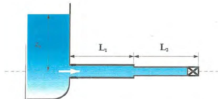
Sl. 15. Proračun 3.2 – cjevovod spremnik-cijev-cijev-ventil
