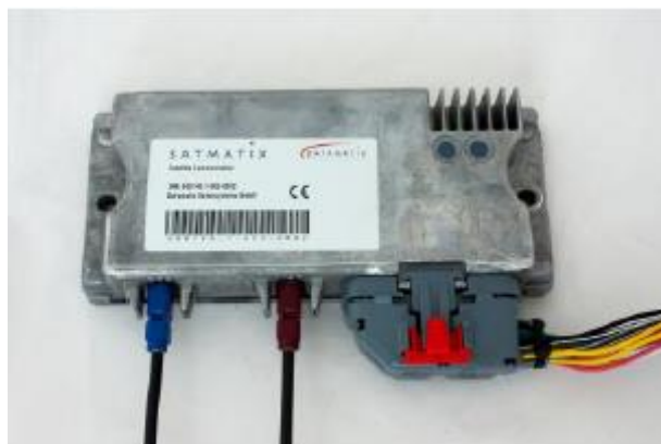
Slika 78. Prikaz uređaja koji omogućuje satelitsko praćenje plovila
