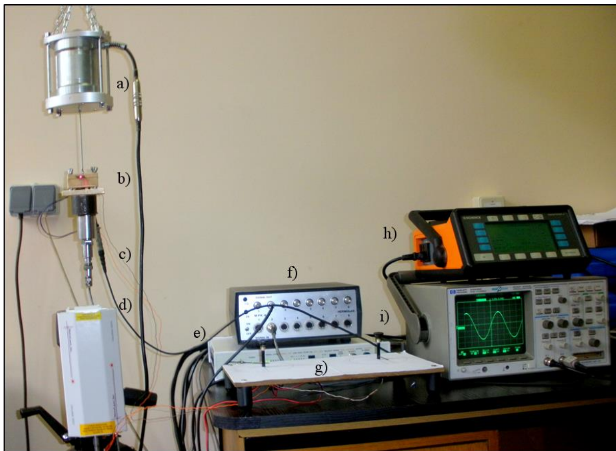
Slika 94. Eksperimentalni postav u Laboratoriju za precizno inženjerstvo: a) vibracijski uzбудnik Schenk AG Vibroexciter 41, b) uklještenje konzole, c) akcelerometar Schenk AS-020, d) laserski vibrometar MetroLaser VibroMet 500V, e) upravljačka jedinica vibrometra, f) upravljačka jedinica akcelerometra, g) potencijometri, h) upravljačka jedinica vibracijskog uzбудnika, i) osciloskop
