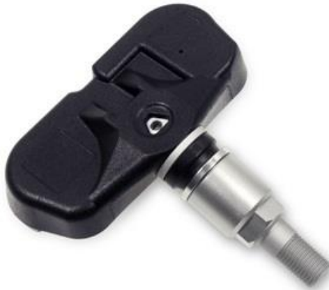
Slika 112. Klasični TPMS uređaj ovdje prikazan sa standardnim automobilskim ventilom i kućištem sa mjernom elektronikom i baterijom [URL: SMP]
