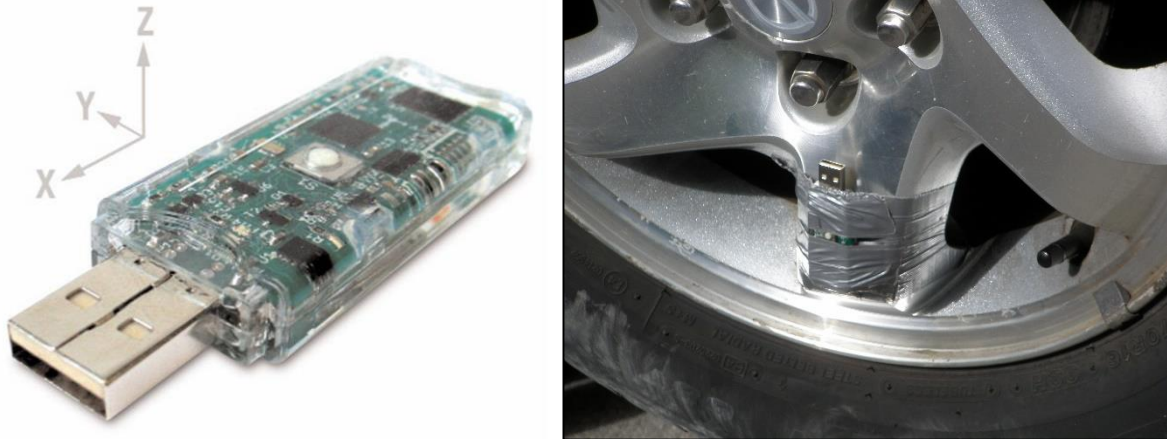
Slika 113. Midé Slam Stick recorder – troosni akcelerometar s prikazom montaže na automobilskom kotaču [URL: Mide]
