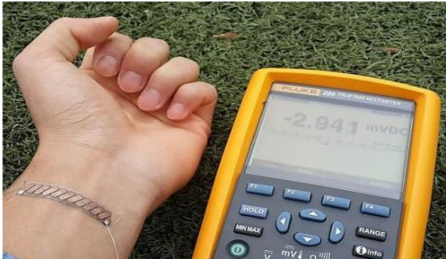
Slika 10. Termoelektrična narukvica [URL: KAIST]
