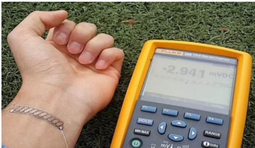
Slika 10. Termoelektrična narukvica [URL: KAIST]
