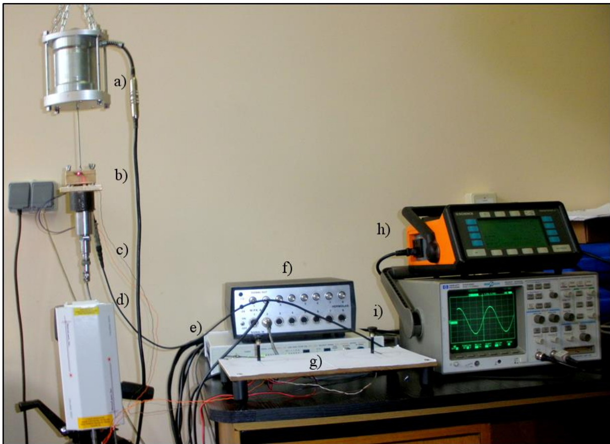
Slika 94. Eksperimentalni postav u Laboratoriju za precizno inženjerstvo: a) vibracijski uzбудnik Schenk AG Vibroexciter 41, b) uklještenje konzole, c) akcelerometar Schenk AS-020, d) laserski vibrometar MetroLaser VibroMet 500V, e) upravljajuća jedinica vibrometra, f) upravljajuća jedinica akcelerometra, g) potencijometri, h) upravljajuća jedinica vibracijskog uzбудnika, i) osciloskop
