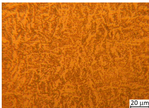
Slika 4.34. Metallografski snimak uzorka 4 neposredno nakon lijevanja, nagrizano 2 %-tnom \text{HNO}_3 u alkoholu, 500:1
