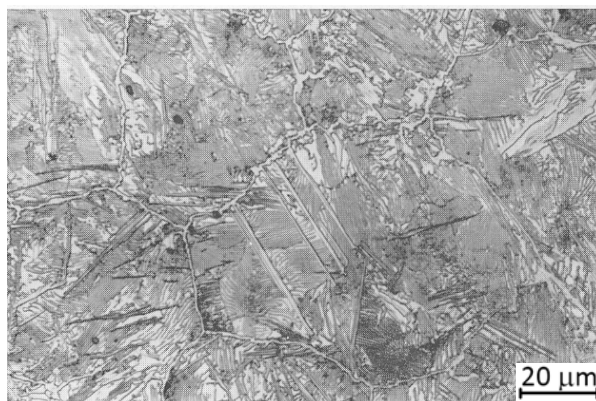
Slika 2.4. Karakteristična mikrostruktura perlita i sekundarnog cementita, 500:1
