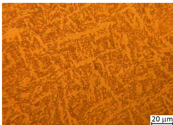
Slika 4.30. Metallografski snimak uzorka 3 neposredno nakon lijevanja, nagrizano 2 %-tnom HNO 3 u alkoholu, 500:1
