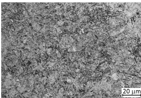
Slika 2.5. Karakteristična mikrostruktura martenzita, 500:1
