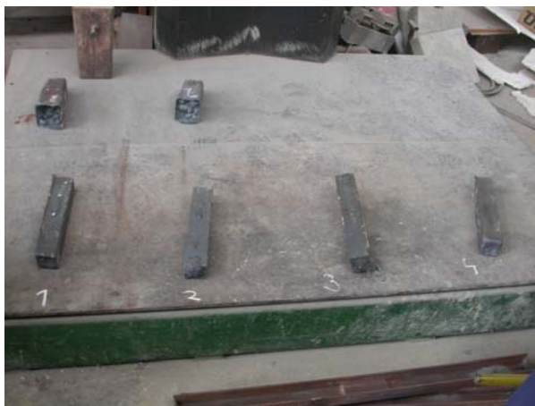
Slika 4.12. Gredice neposredno nakon lijevanja
