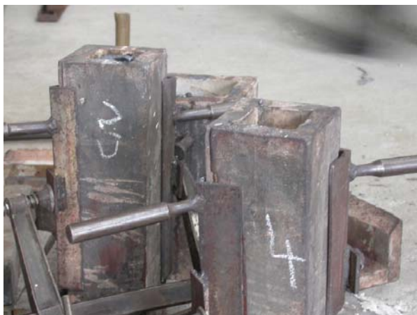
Slika 4.10. Kokile pripremljene za lijevanje
