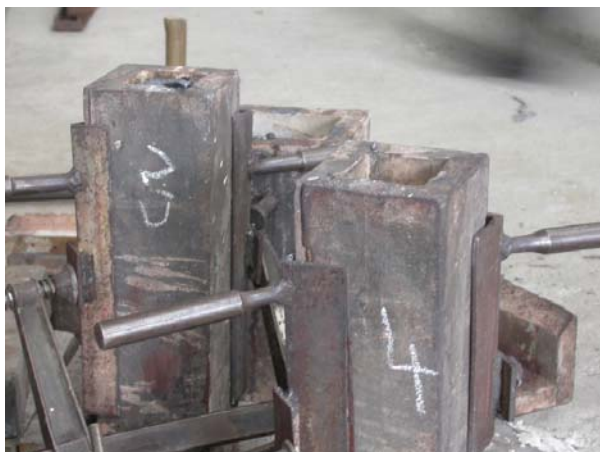
Slika 4.10. Kokile pripremljene za lijevanje
