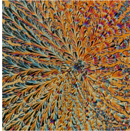
Il. 15 – Unakrsno polarizirana optička mikro-fotografija supermolekule nastale u vodi od amfilifiličnih linearno-dentričkih kopolimera
