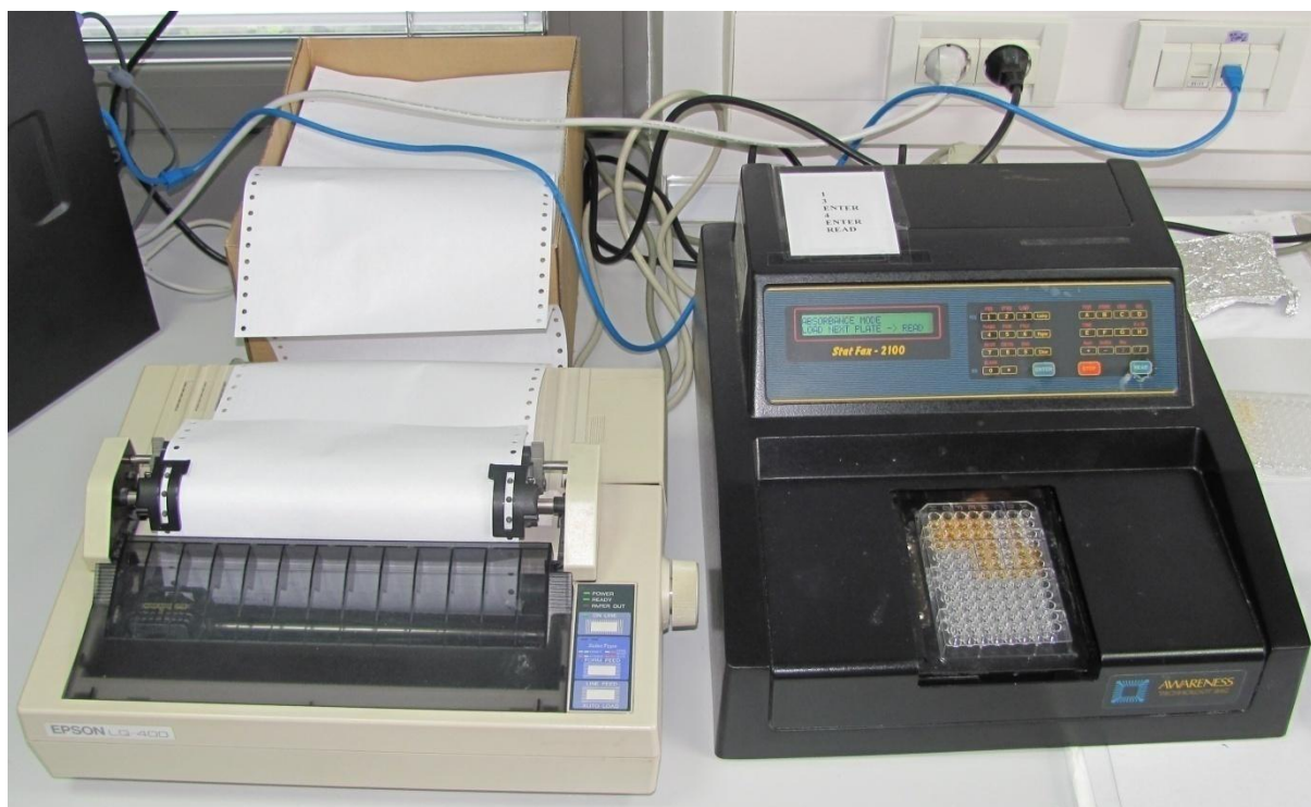
Slika 16. Spektrofotometar Stat Fax 2010 za očitavanje razine biljega oksidacijskog stresa
