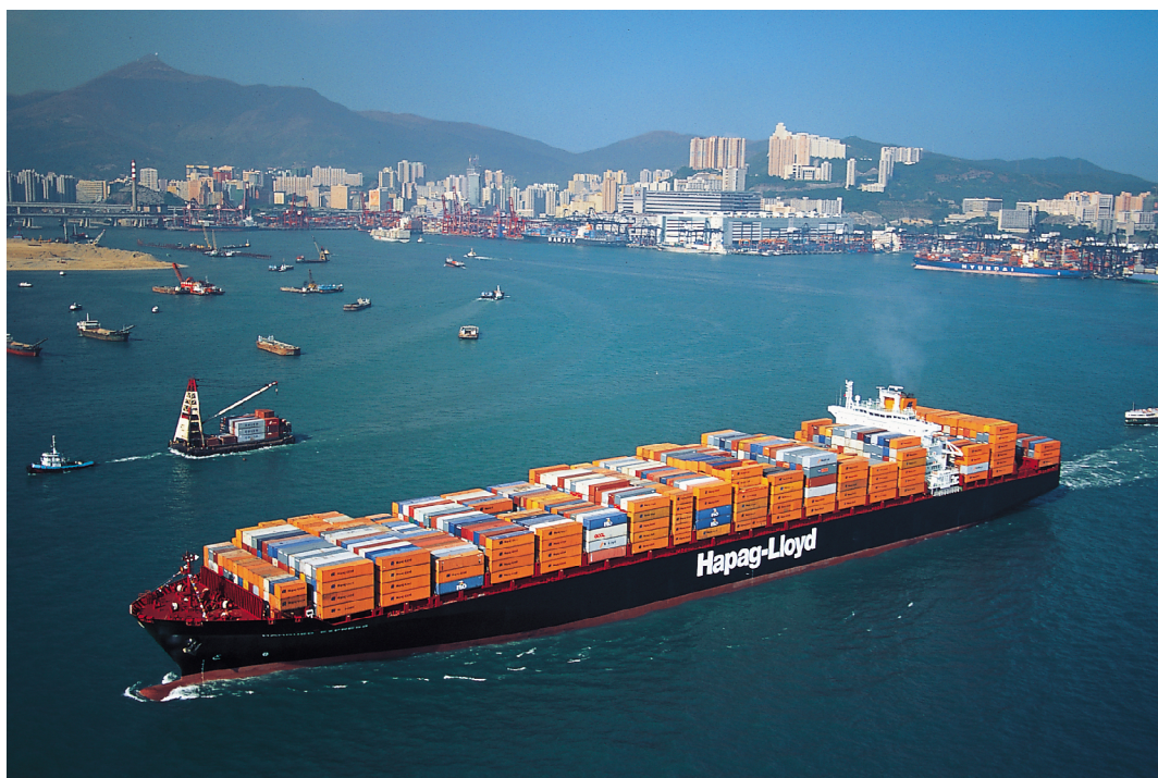
Slika 1.1: Hamburg Express: kontejnerski brod 7 500 teu nosivosti, dužine 320 m, širine 43 m gaza 14,5 m, maksimalne brzine 25 čvora, istisnine 100 000 tdw [2], pogonjen dizelskim motorom snage 68 640 kW
