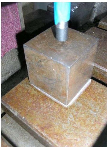
Slika 4.15. Prikaz mjerenja prigušenja u brtvi
