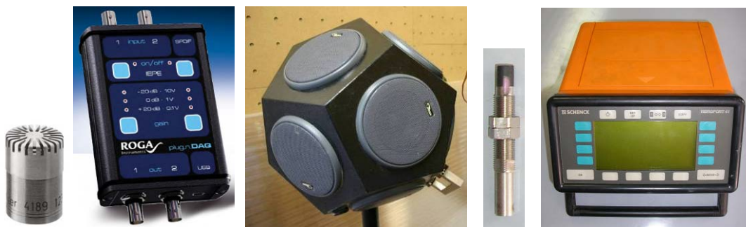
Slika 4.9. Mjerna oprema (redom: mikrofon, mjerna kartica, omnodirekcijski zvučnik, senzor za vibracije i mjerni uređaj Vibroport 41)
