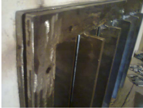
Slika 4.19. Dva periodična okvira na konstantnoj udaljenosti s ciljem definiranja krutosti poprečne opruge u osloncima
