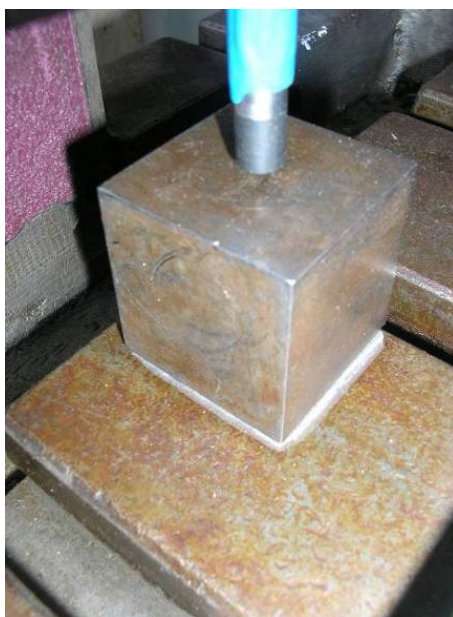
Slika 4.15. Prikaz mjerenja prigušenja u brtvi
