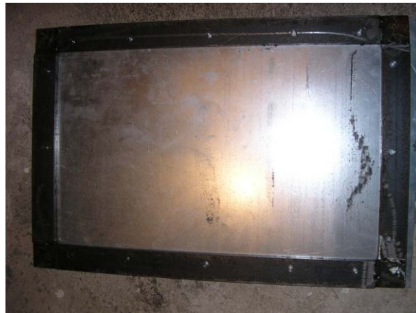
Slika 4.7. Okvir za vanjski rub panela
