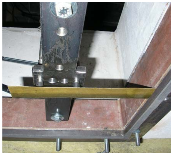
Slika 4.11. Provjera frekvencije 1. oblika vibriranja
