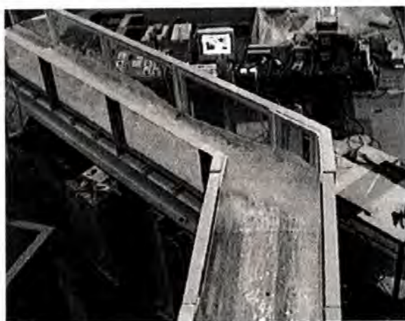
Slika 4.13. Strujanje kroz kanal i reflektirani val koji se formira na pregibu (pogled nizvodno)
