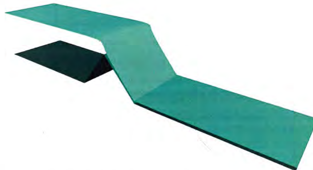
Slika 4.4. Vodno lice dobiveno 2D modelom plitkih voda
