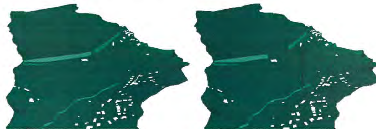
Slika 5.8. Početak i kraj širenja propusta u brani Tribalj pomoću zadavanja vremenski promjenjive numeričke mreže
