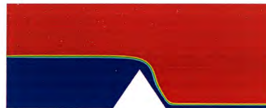
Slika 4.10. Distribucija faza (voda-zrak) u osi kanala
