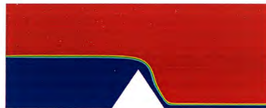
Slika 4.10. Distribucija faza (voda-zrak) u osi kanala
