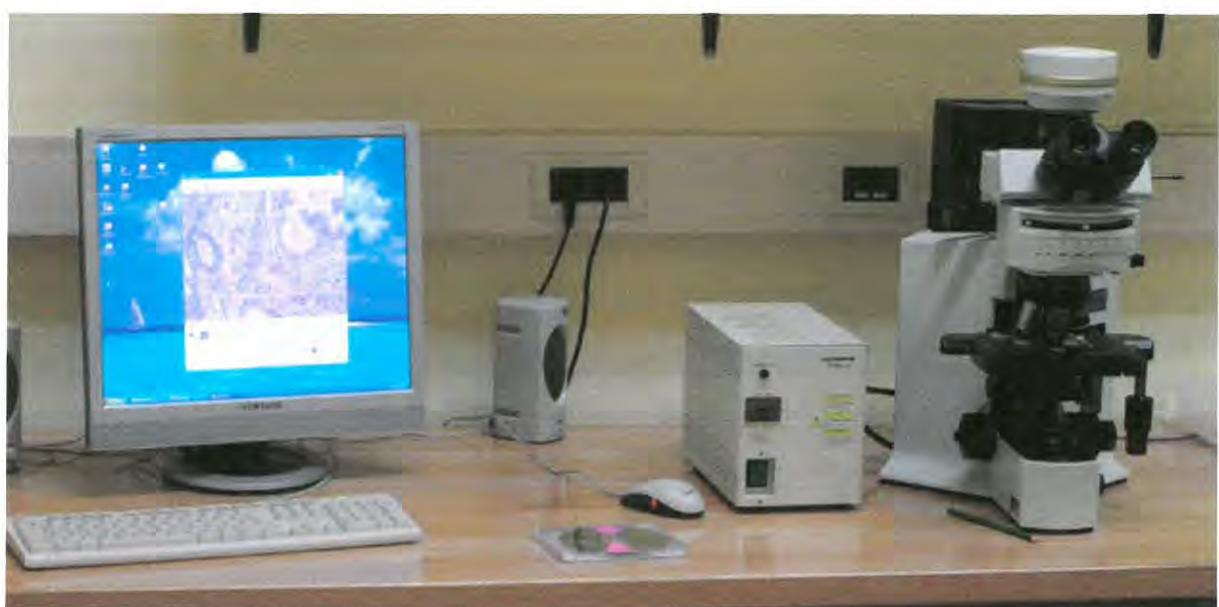
*Slika 17. Sustav za analizu slike (image analyzer system)*
